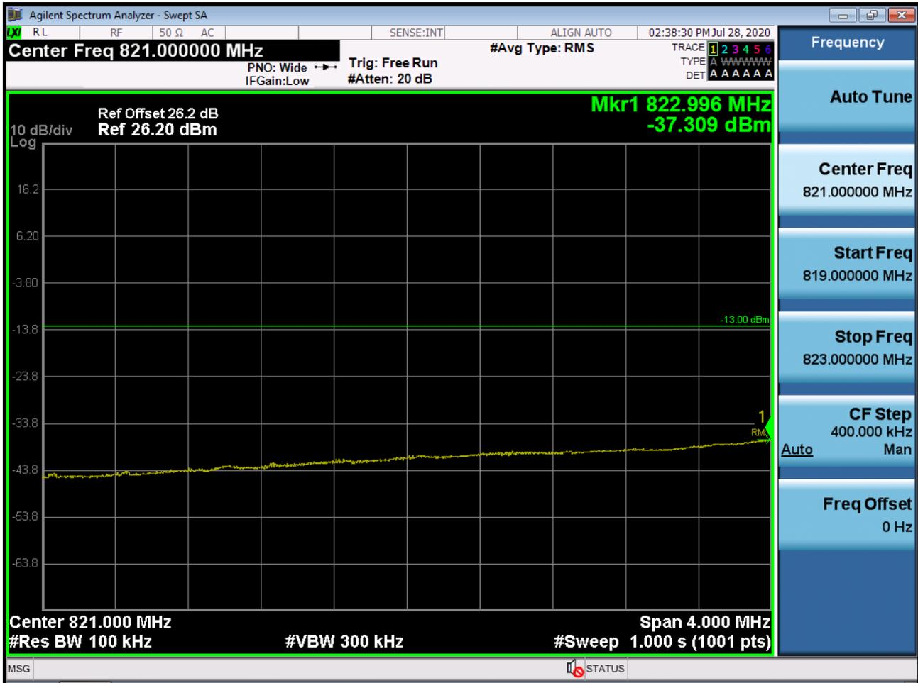
BAND 26. Lower Band Edge Plot (15M BW Ch.26865 QPSK\_RB75\_Offset 0) -1
