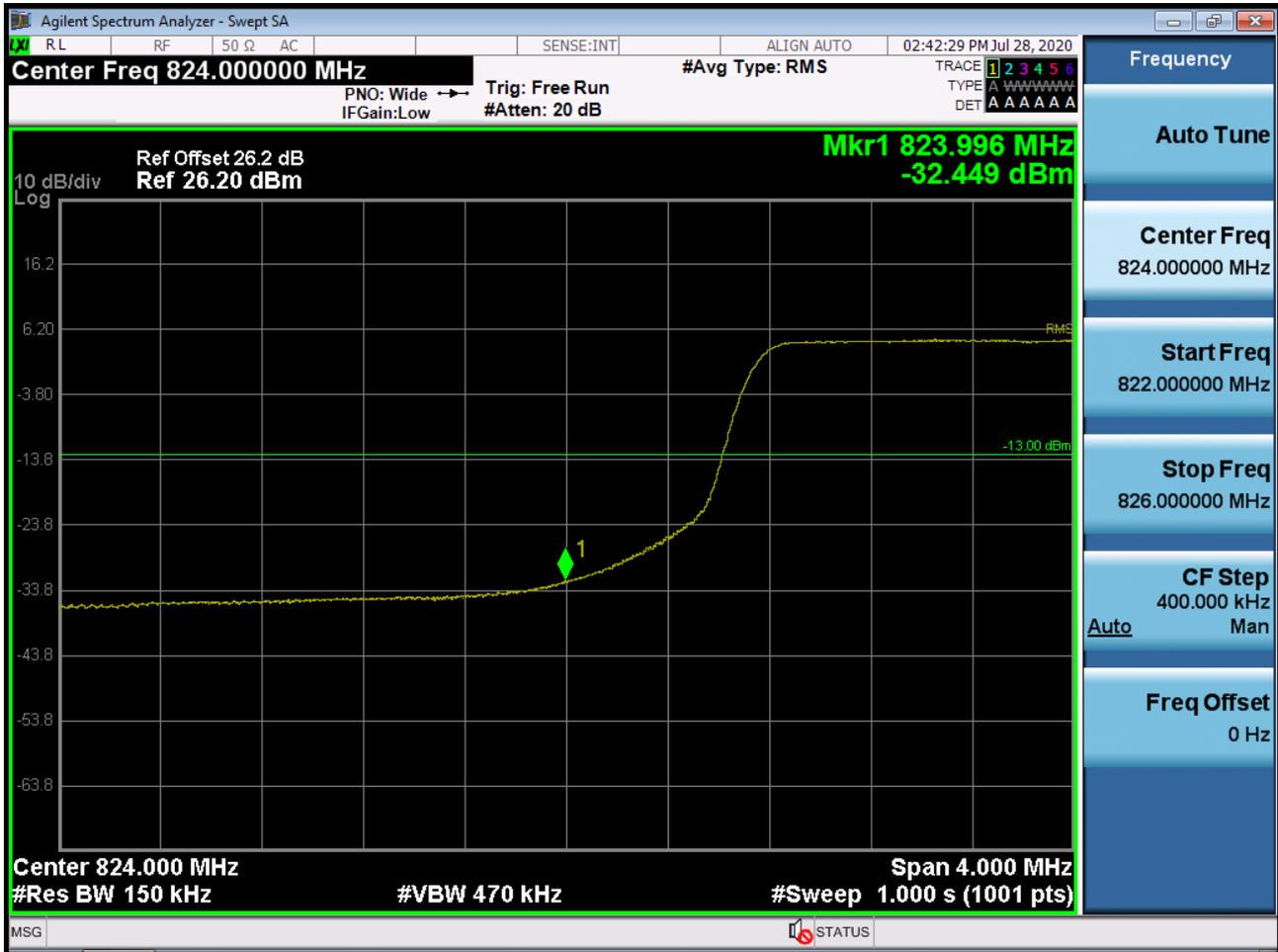
BAND 26. Lower Extended Band Edge Plot (15M BW Ch.26865 QPSK\_RB75\_0) -3
