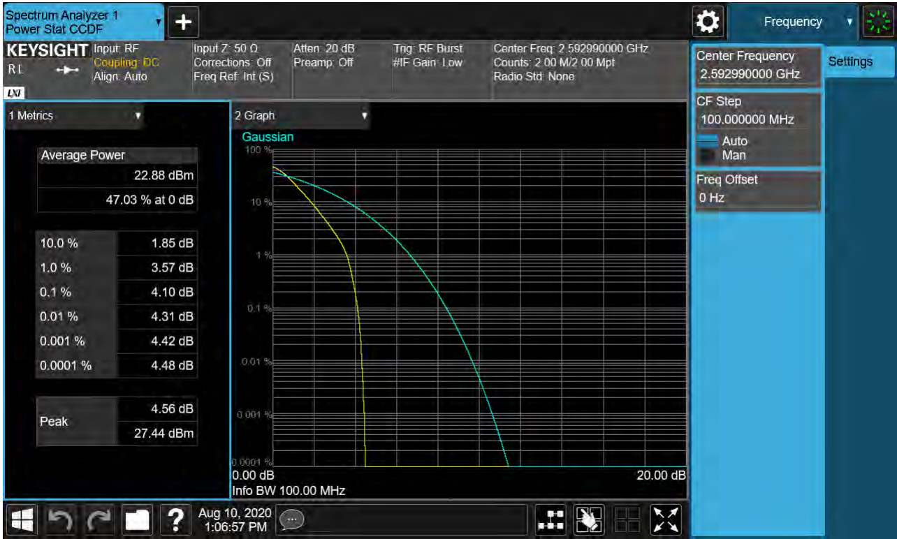
Sub6 n41. PAR Plot (100M BW_Ch.518598_BPSK_RB25_0)
