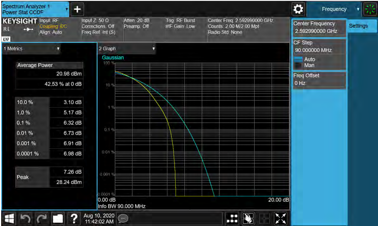
Sub6 n41. PAR Plot (90M BW_Ch.518598_64QAM_RB25_0)
