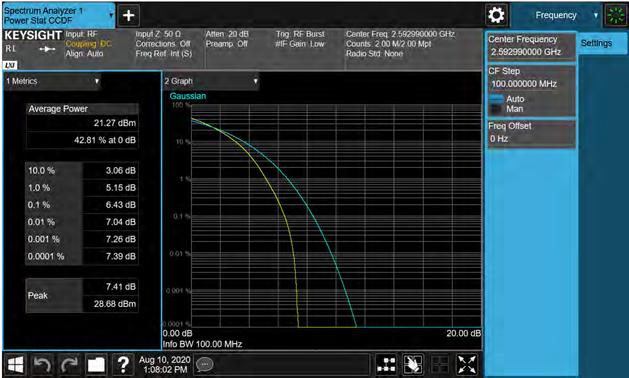
Sub6 n41. PAR Plot (100M BW_Ch.518598_64QAM_RB25_0)
