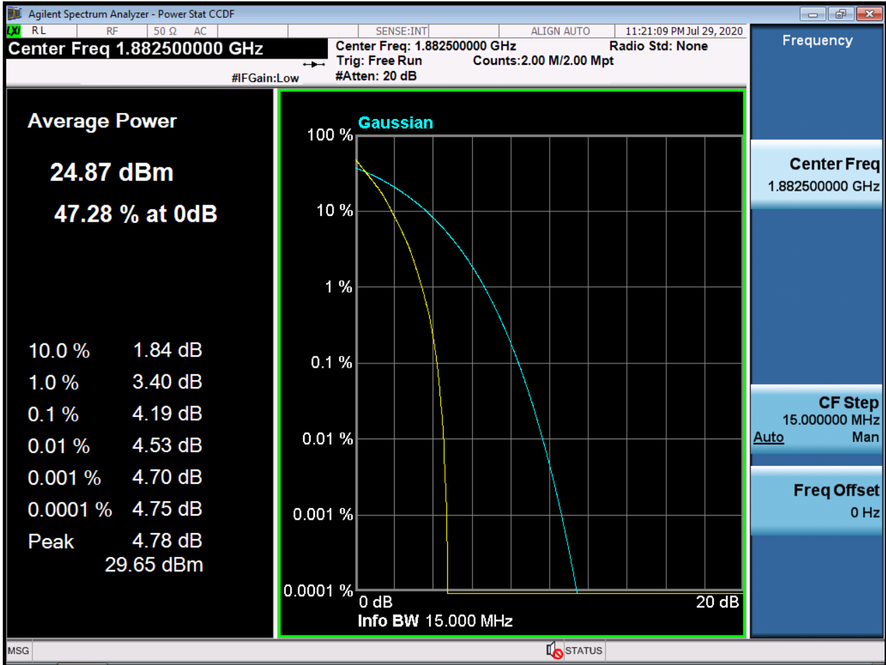
Sub6 n25(2). PAR Plot (15M BW Ch.376500 BPSK RB 75_0)
