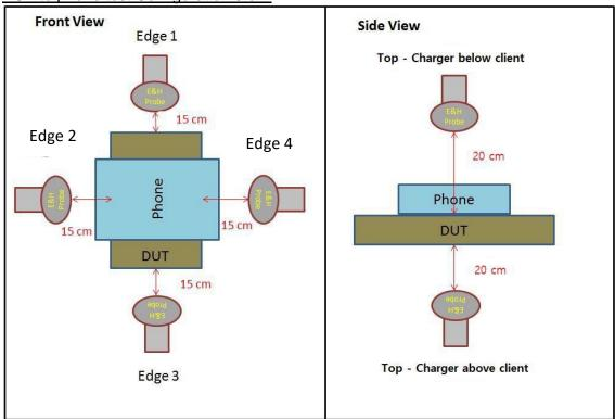
DUT to Watch test Configuration 5 & 6 **Front View** Side View Edge 1 Top - Charger below client 15 cm Edge 4 Edge 2 Watch 20 cm 15 cm 15 cm Watch DUT DUT 15 cm Edge 3
