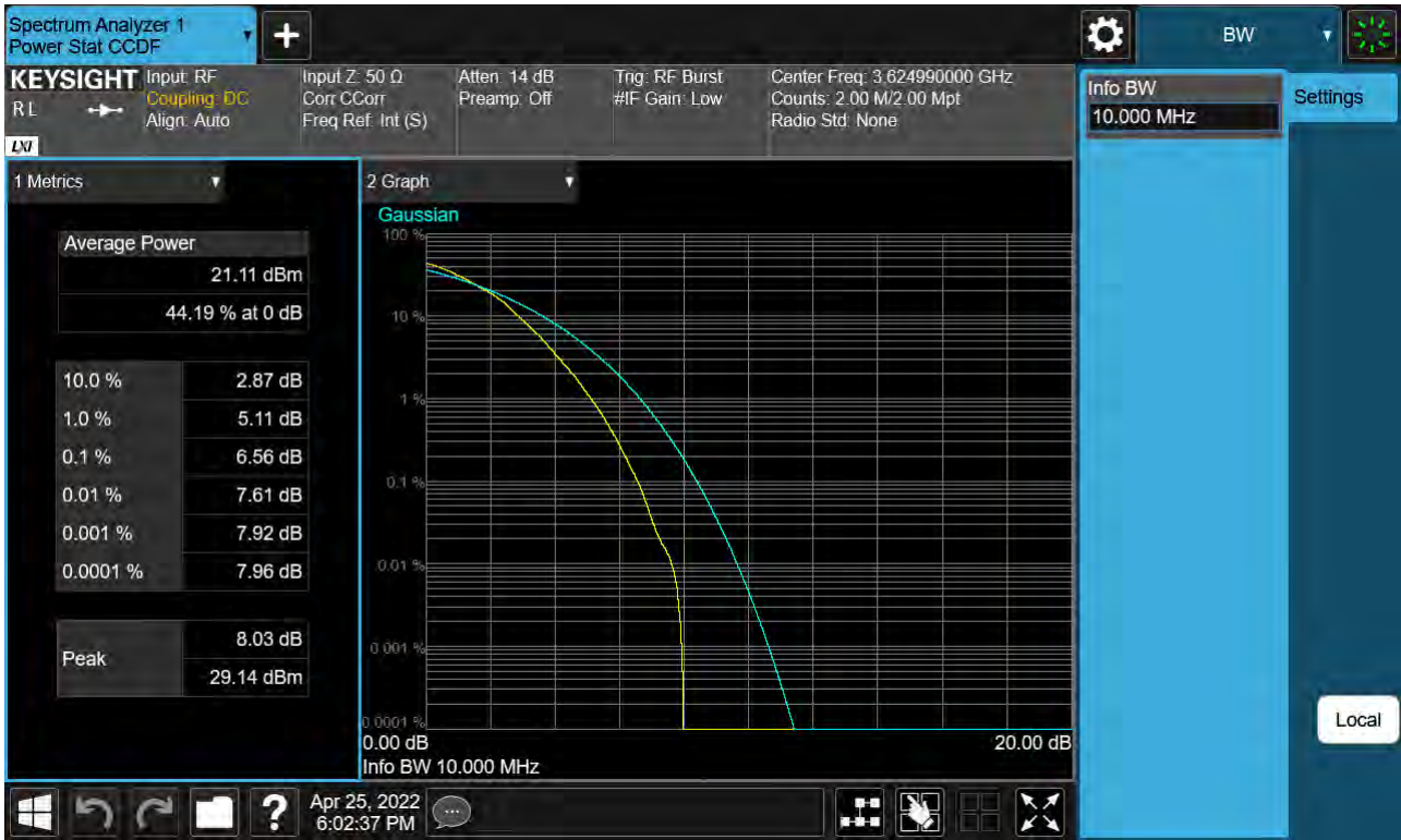
Sub6 n48. PAR Plot (10 MHz Ch.641666 64-QAM RB 24)
