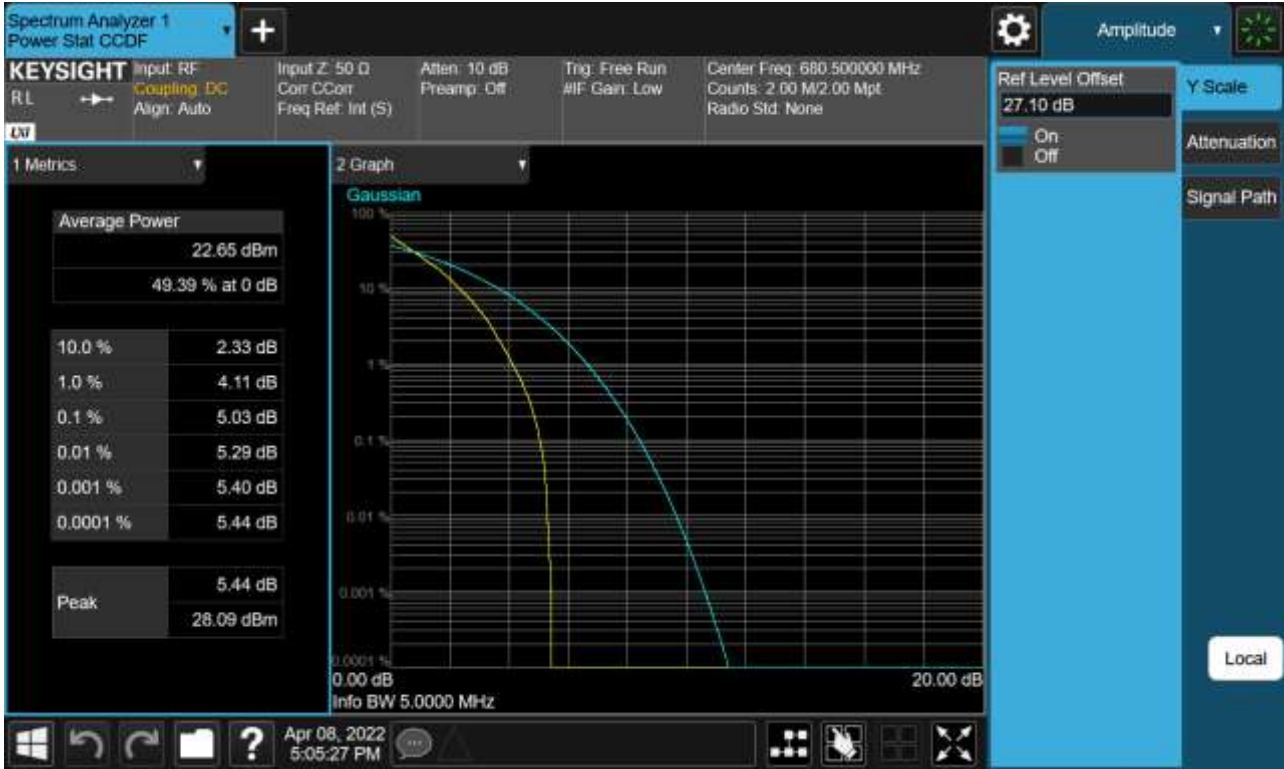
Sub6 n71. PAR Plot (5 M BW_Ch.349000_QPSK_Full RB)
