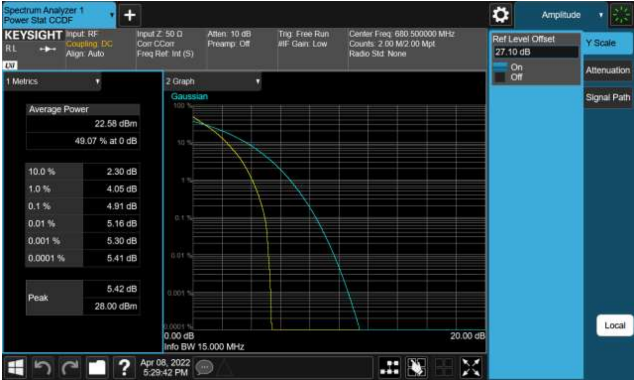
Sub6 n71. PAR Plot (15 M BW_Ch.349000_QPSK_Full RB)
