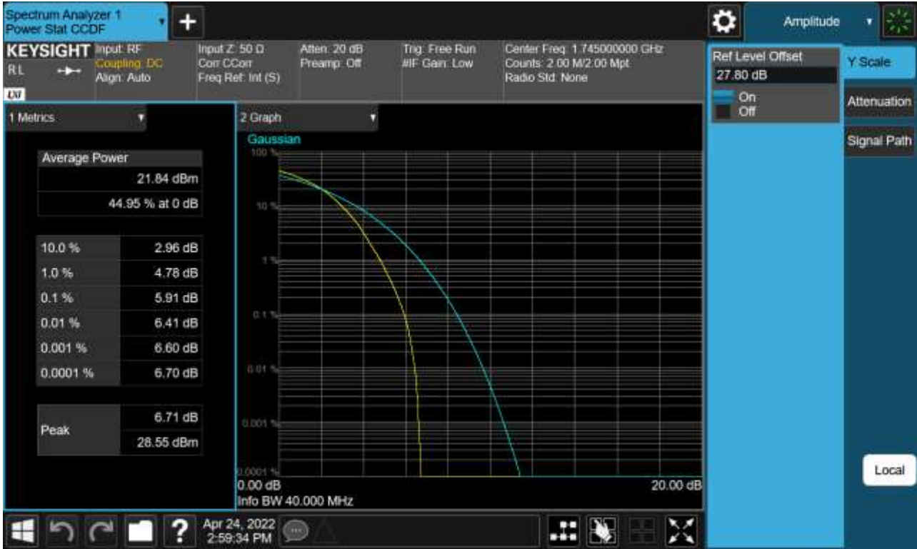
Sub6 n66. PAR Plot (40 M BW_Ch.349000_64QAM_Full RB)
