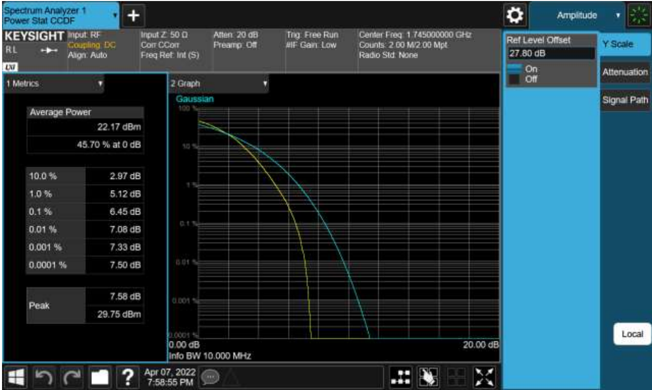
Sub6 n66. PAR Plot (10 M BW_Ch.349000_64QAM_Full RB)
