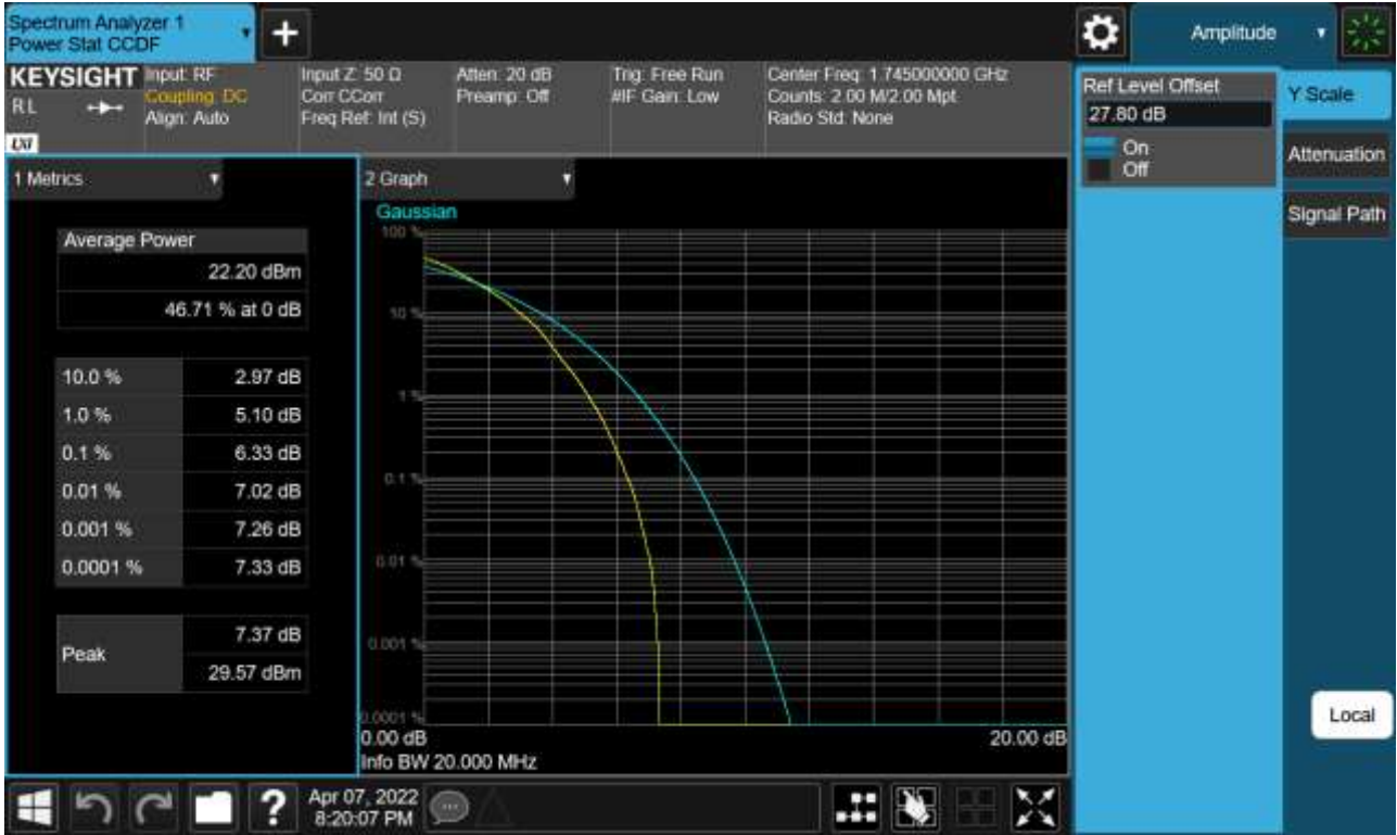
Sub6 n66. PAR Plot (20 M BW_Ch.349000_64QAM_Full RB)
