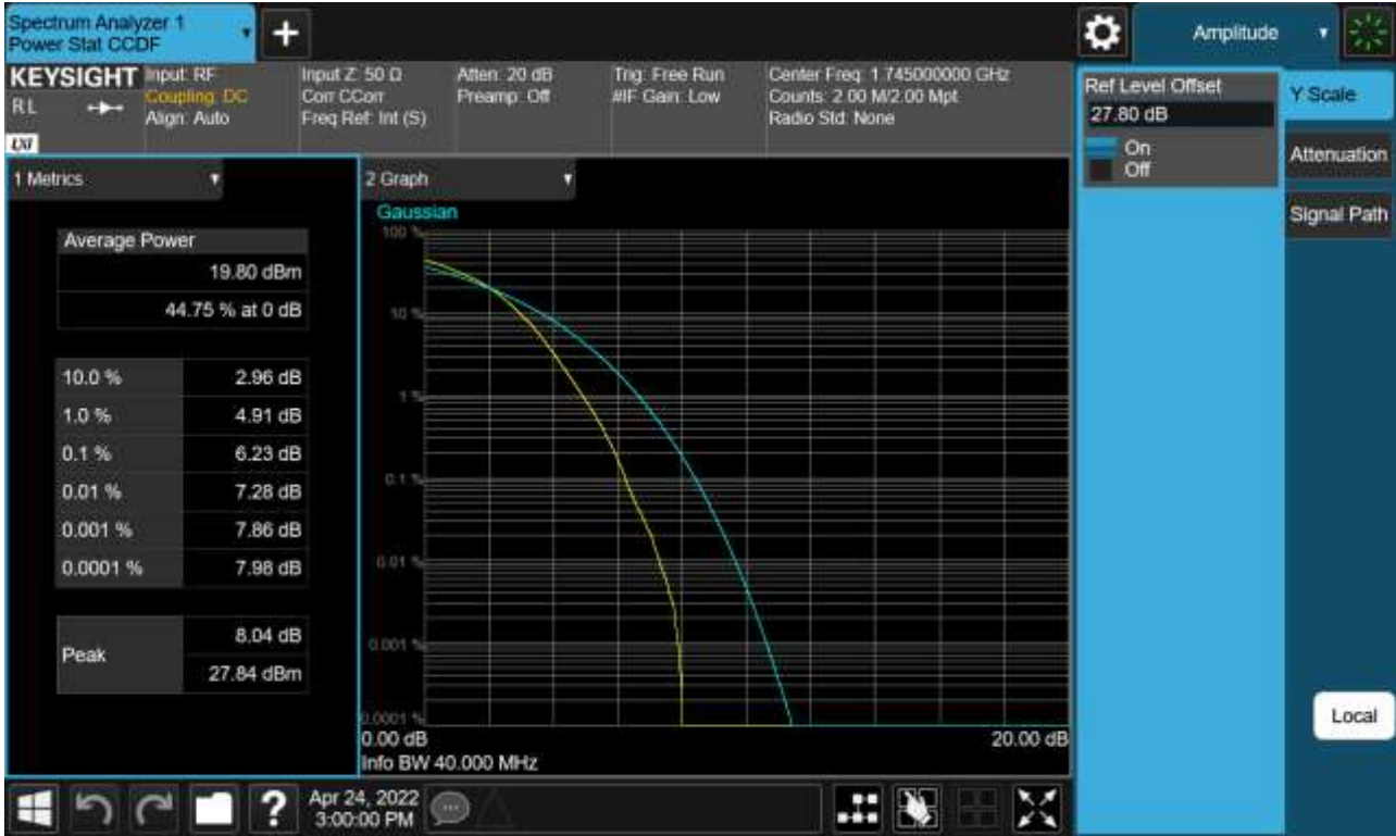
Sub6 n66. PAR Plot (40 M BW_Ch.349000_256QAM_Full RB)
