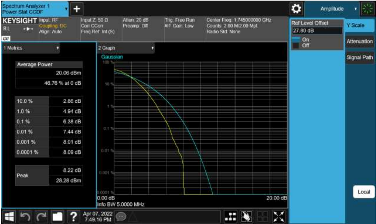
Sub6 n66. PAR Plot (5 M BW_Ch.349000_256QAM_Full RB)
