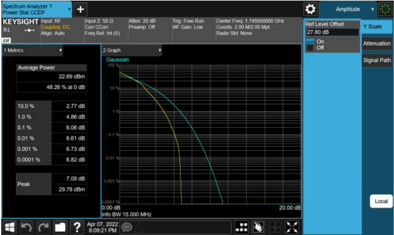
Sub6 n66. PAR Plot (15 M BW_Ch.349000_16QAM_Full RB)
