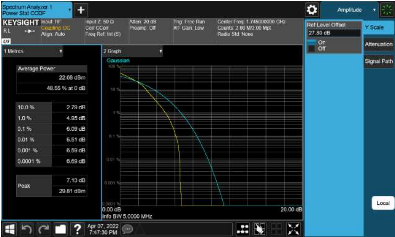
Sub6 n66. PAR Plot (5 M BW_Ch.349000_16QAM_Full RB)
