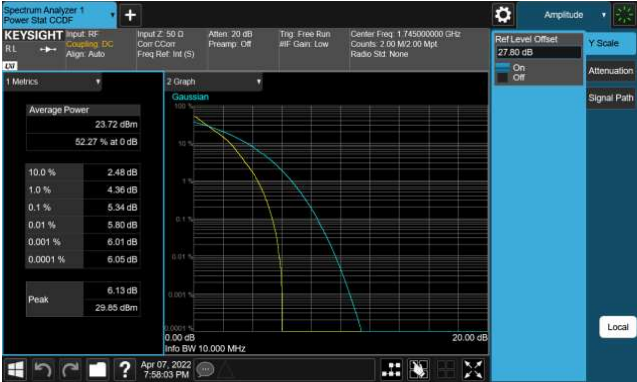
Sub6 n66. PAR Plot (10 M BW_Ch.349000_QPSK_Full RB)
