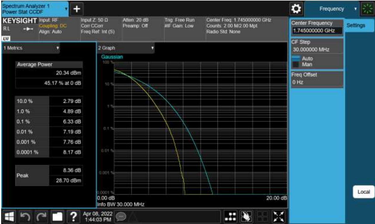
Sub6 n66. PAR Plot (30 M BW_Ch.349000_256QAM_Full RB)
