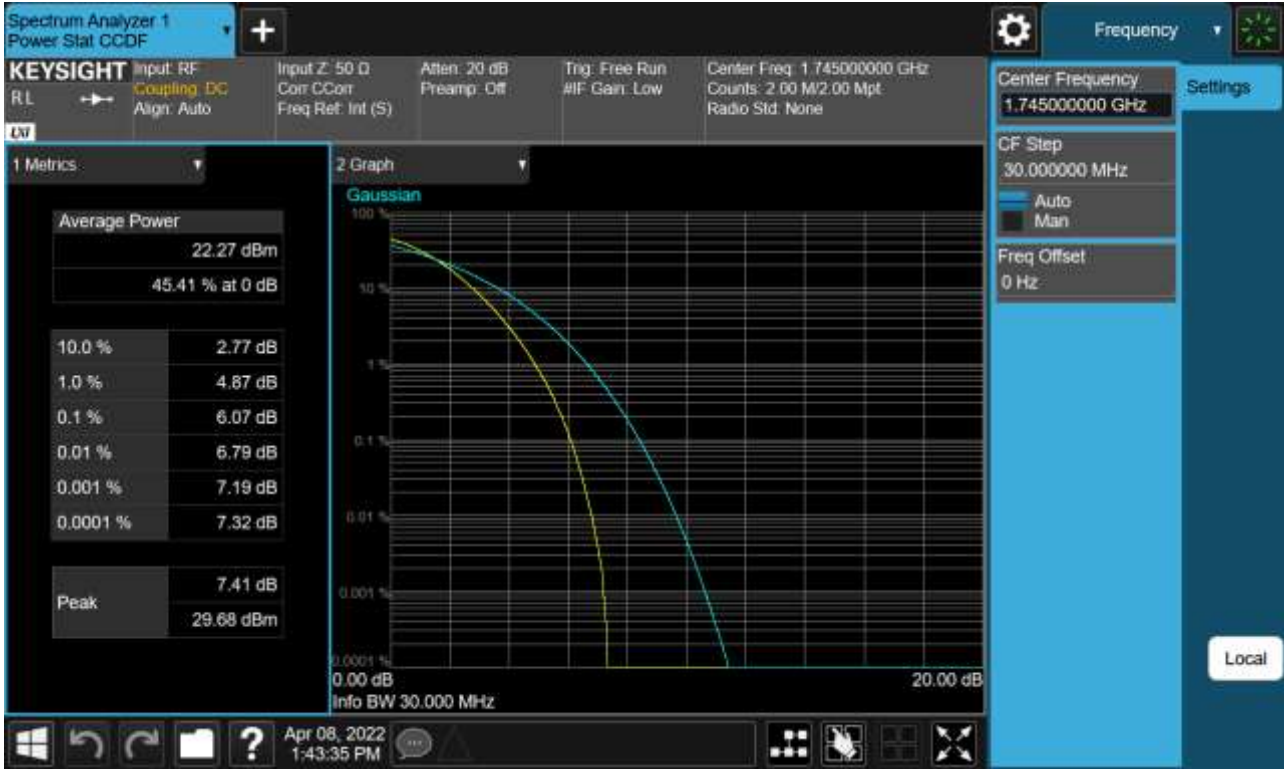
Sub6 n66. PAR Plot (30 M BW_Ch.349000_64QAM_Full RB)
