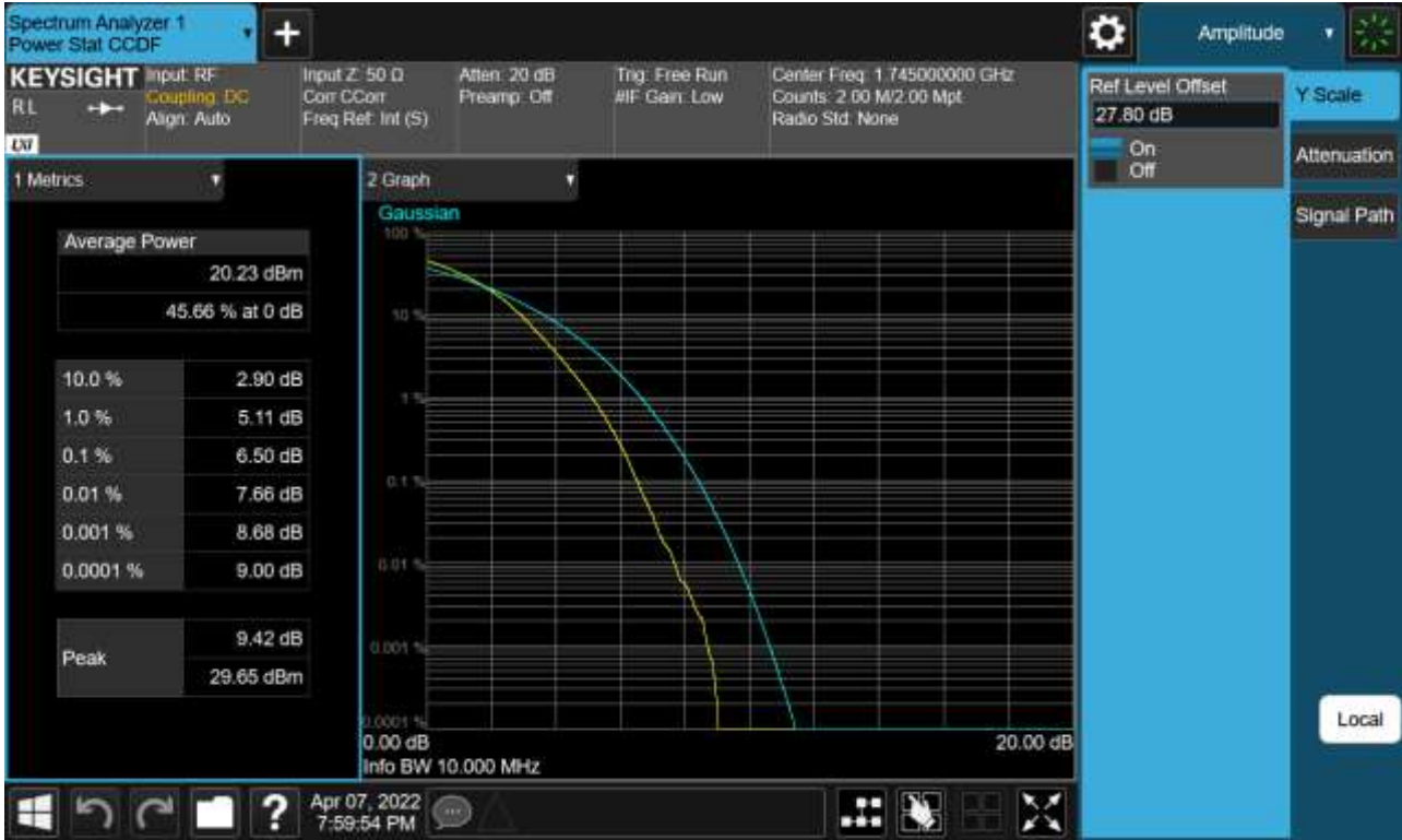
Sub6 n66. PAR Plot (10 M BW_Ch.349000_256QAM_Full RB)
