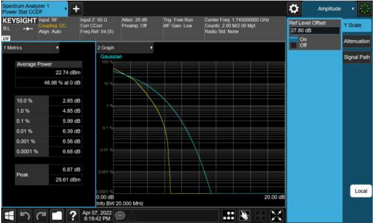
Sub6 n66. PAR Plot (20 M BW_Ch.349000_16QAM_Full RB)
