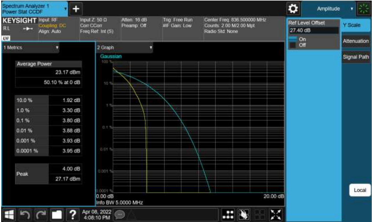
Sub6 n5. PAR Plot (5 M BW_Ch.167300_BPSK_Full RB_0)
