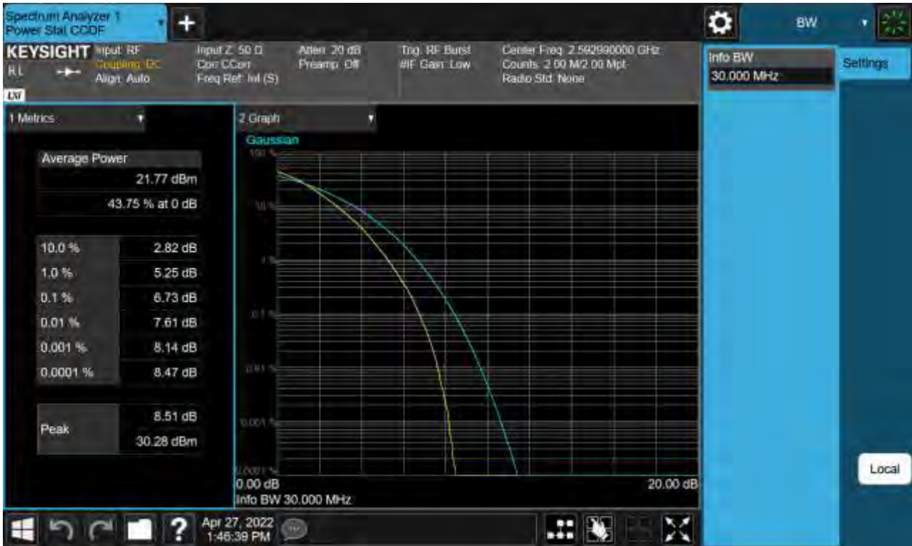
Sub6 n41. PAR Plot (30 M BW_Ch.518598_256QAM)
