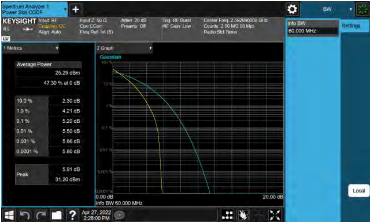
Sub6 n41. PAR Plot (60 M BW_Ch.518598_QPSK)
