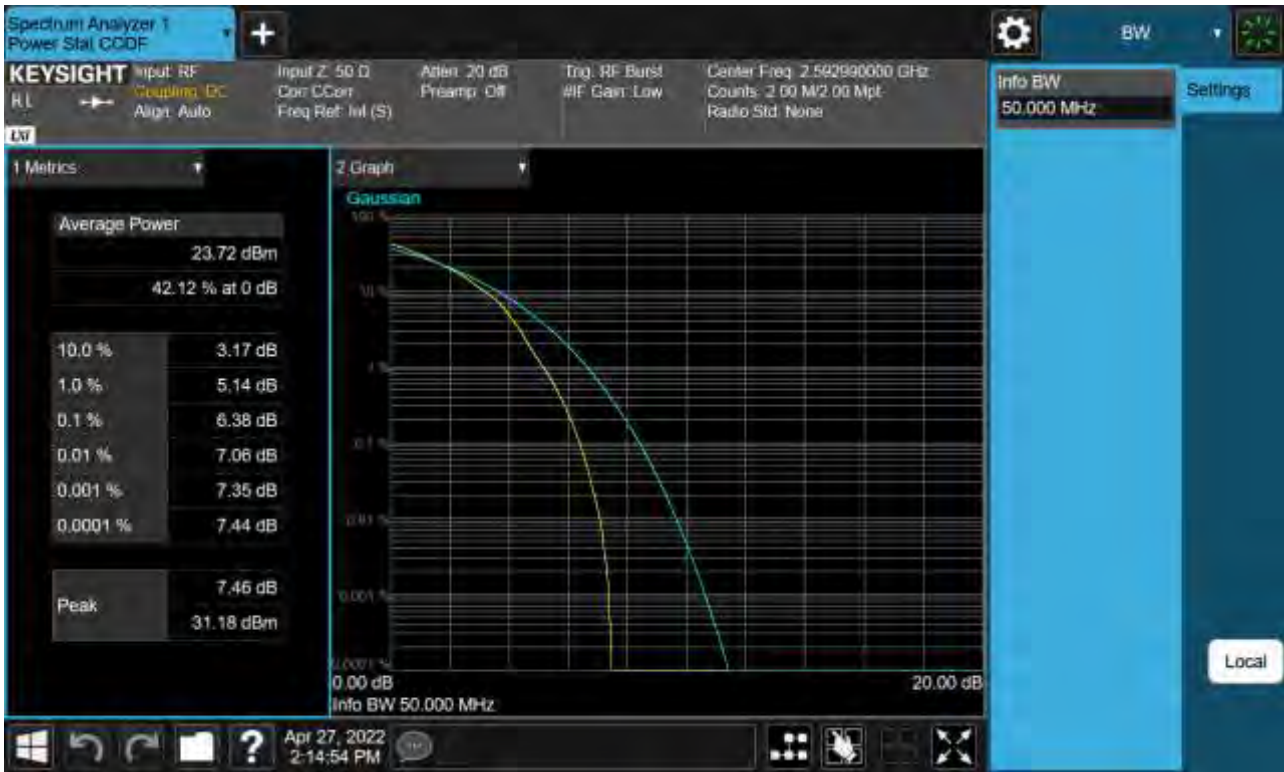
Sub6 n41. PAR Plot (50 M BW_Ch.518598_64QAM)
