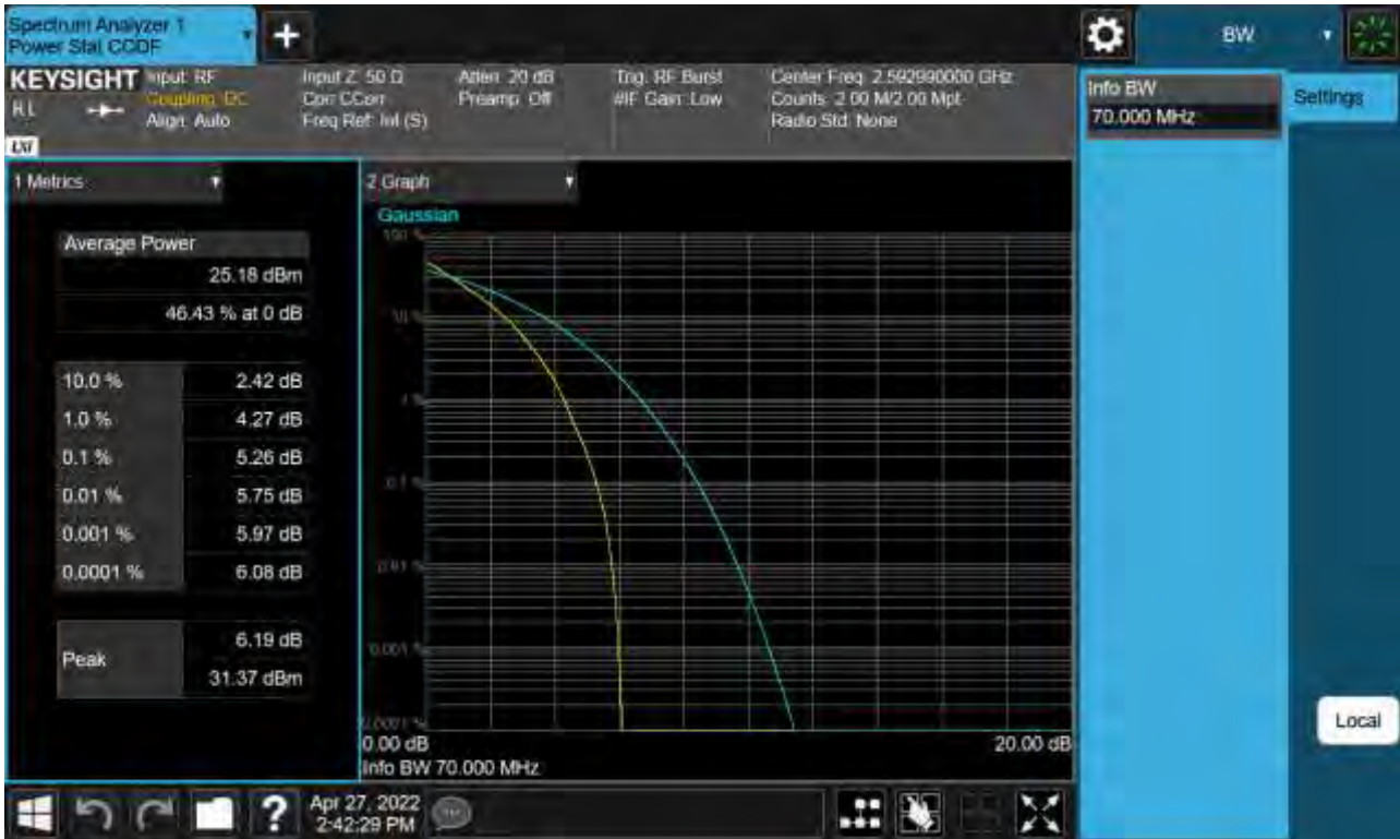
Sub6 n41. PAR Plot (70 M BW_Ch.518598_QPSK)
