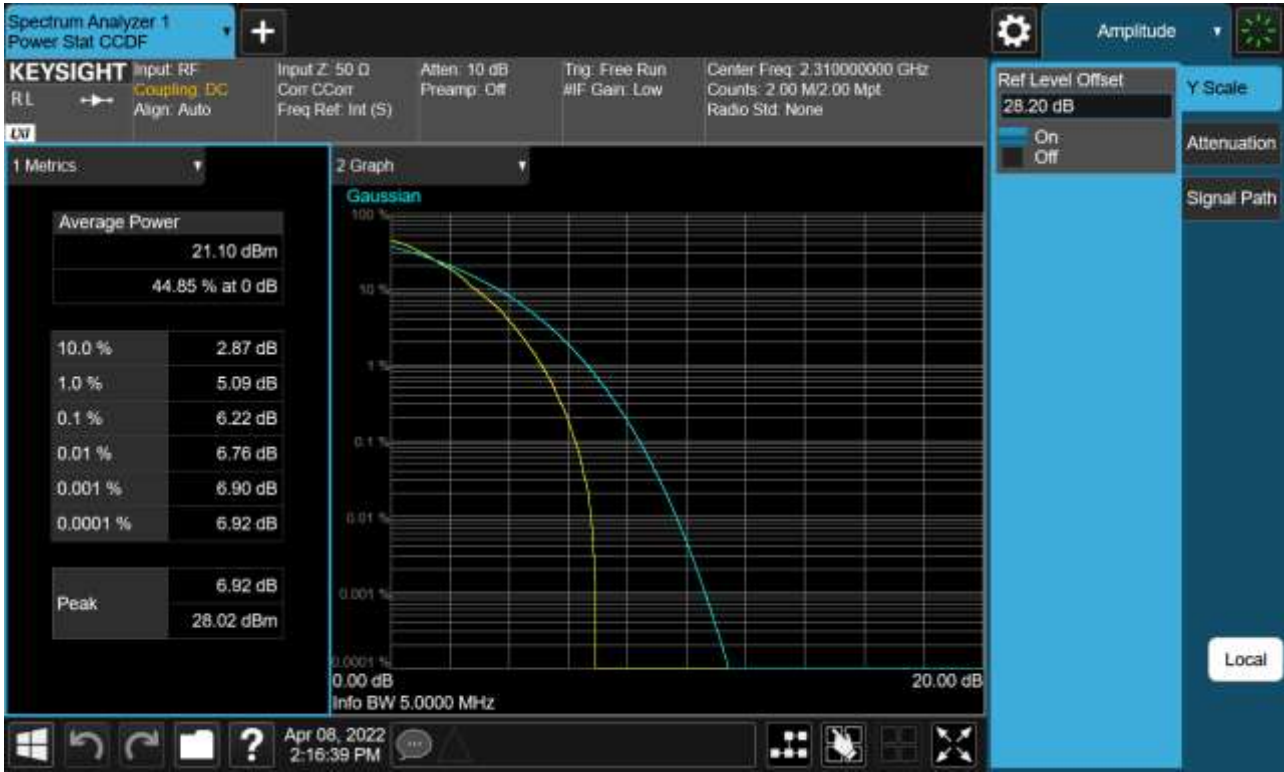
Sub6 n30. PAR Plot (5 M BW_Ch.462000_64QAM_RB25_0)
