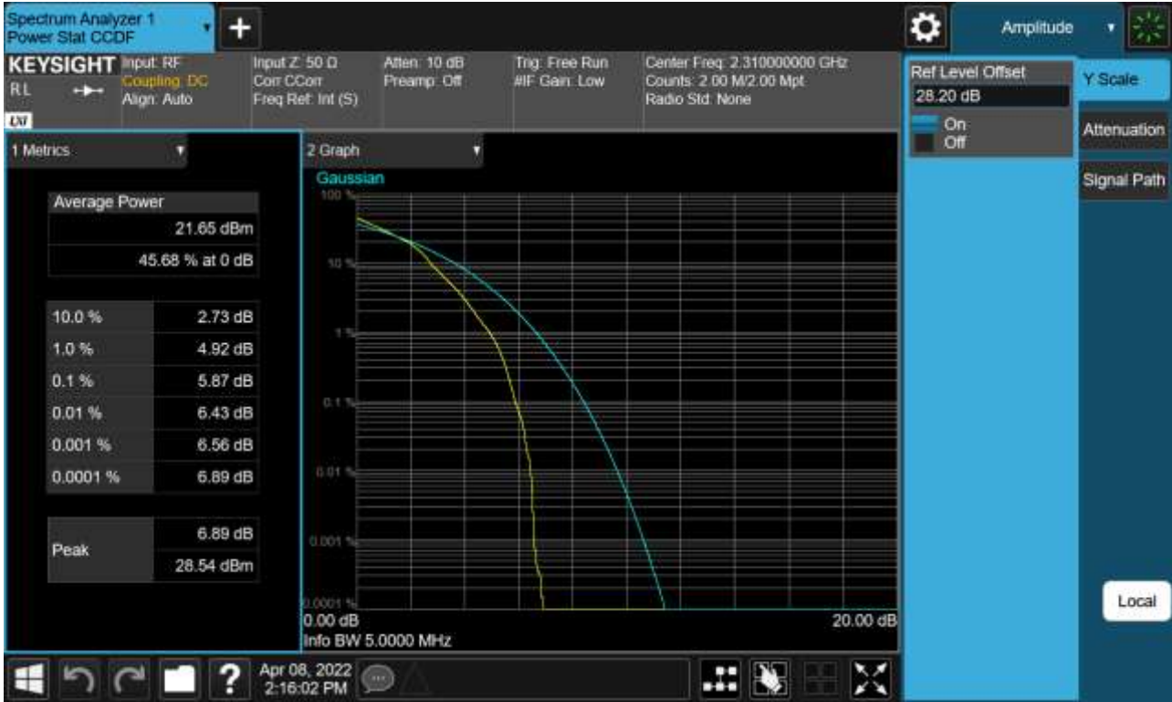
Sub6 n30. PAR Plot (5 M BW_Ch.462000_16QAM_RB25_0)
