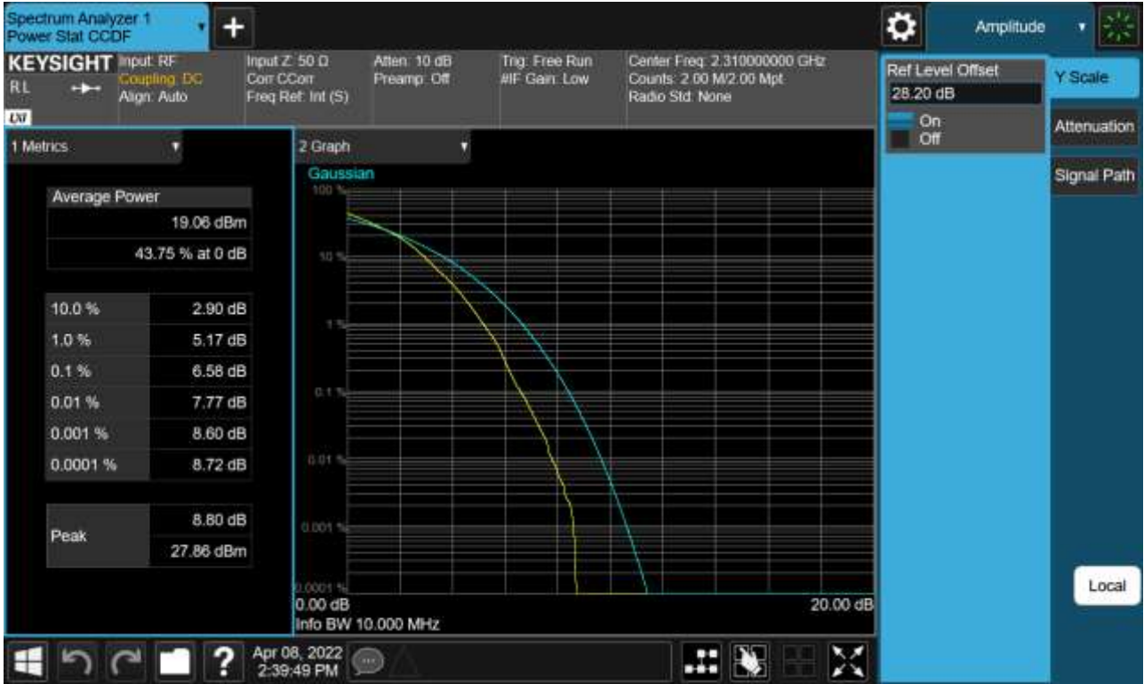
Sub6 n30. PAR Plot (10 M BW_Ch.462000_256QAM_RB50_0)
