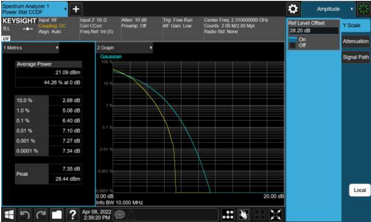
Sub6 n30. PAR Plot (10 M BW_Ch.462000_64QAM_RB50_0)
