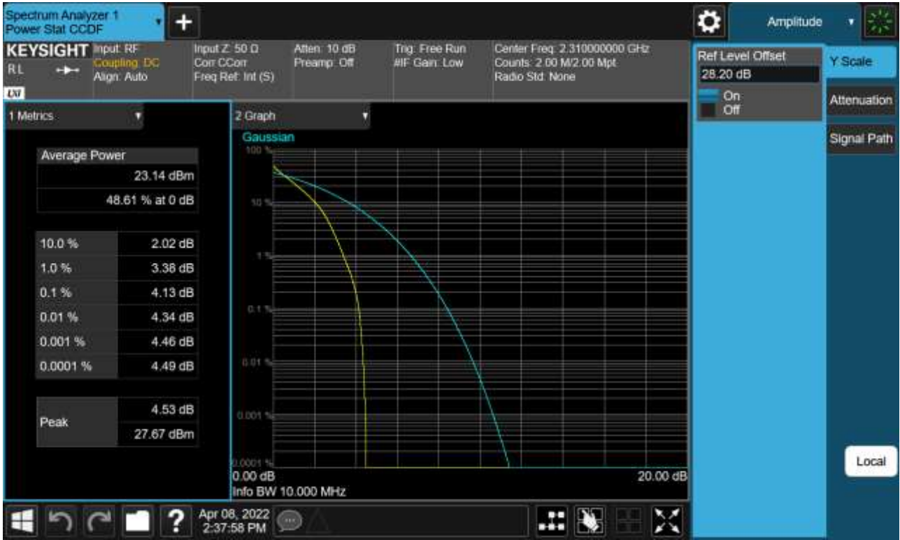
Sub6 n30. PAR Plot (10 M BW_Ch.462000_BPSK_RB50_0)
