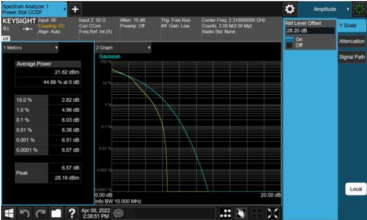
Sub6 n30. PAR Plot (10 M BW_Ch.462000_16QAM_RB50_0)
