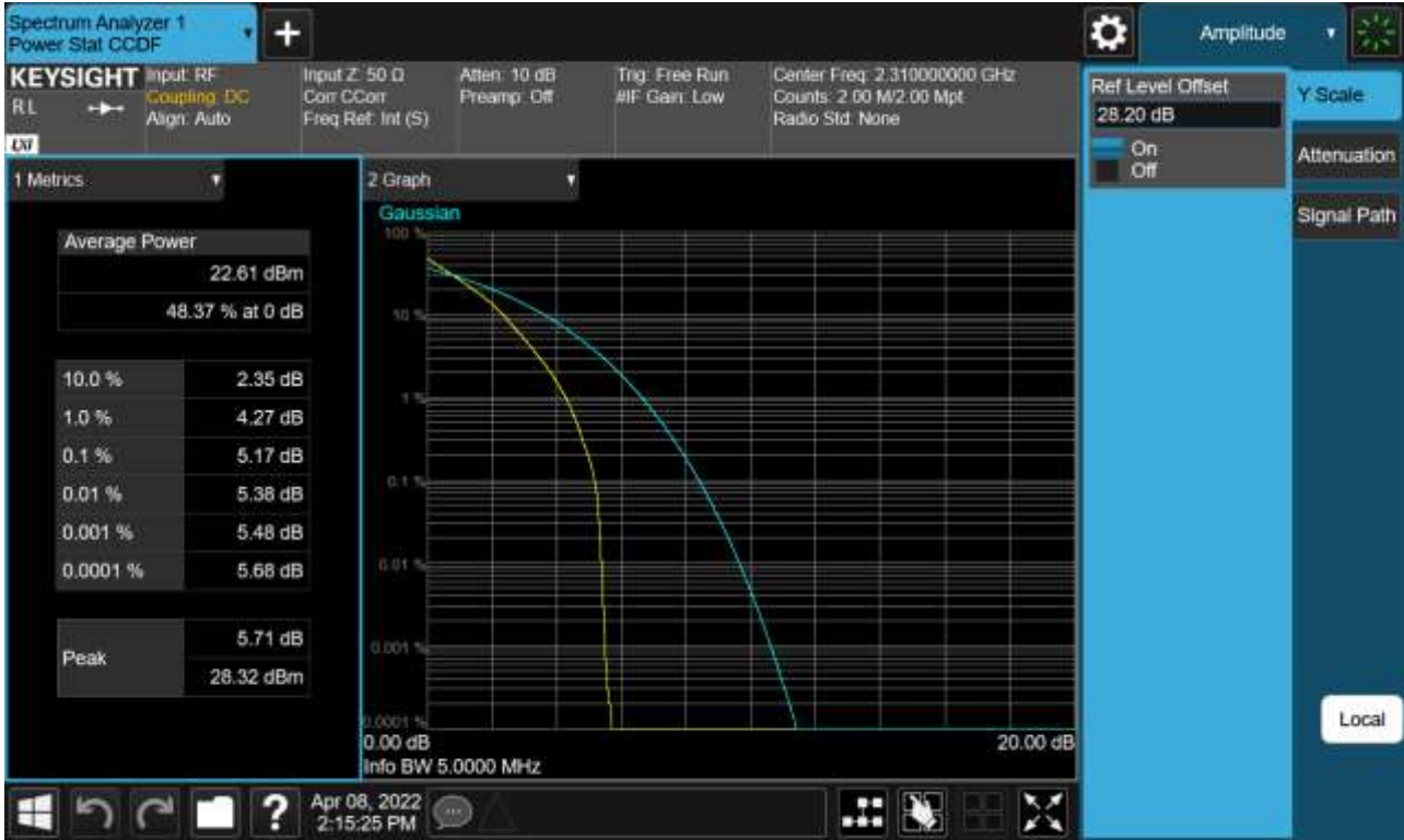
Sub6 n30. PAR Plot (5 M BW_Ch.462000_QPSK_RB25_0)
