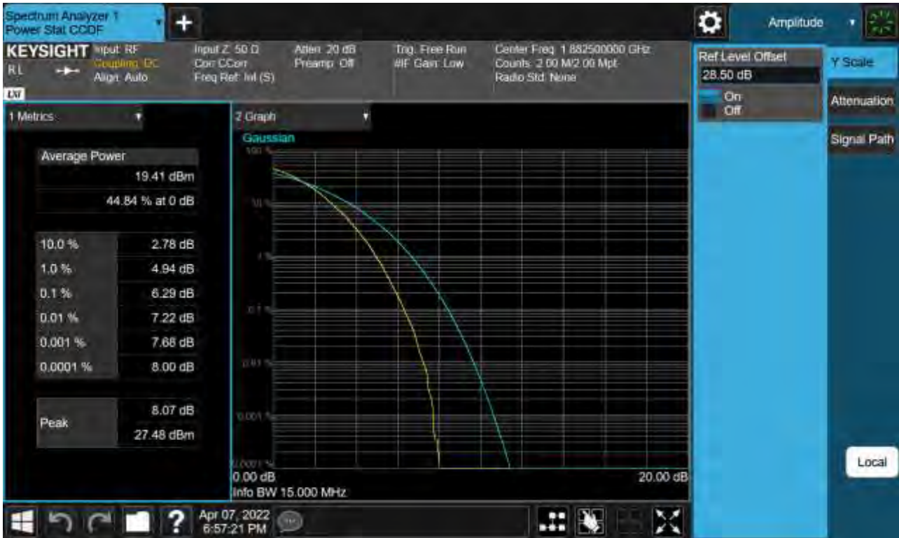
Sub6 n25(2). PAR Plot (15 M BW Ch.376500 256QAM _ Full RB _0)
