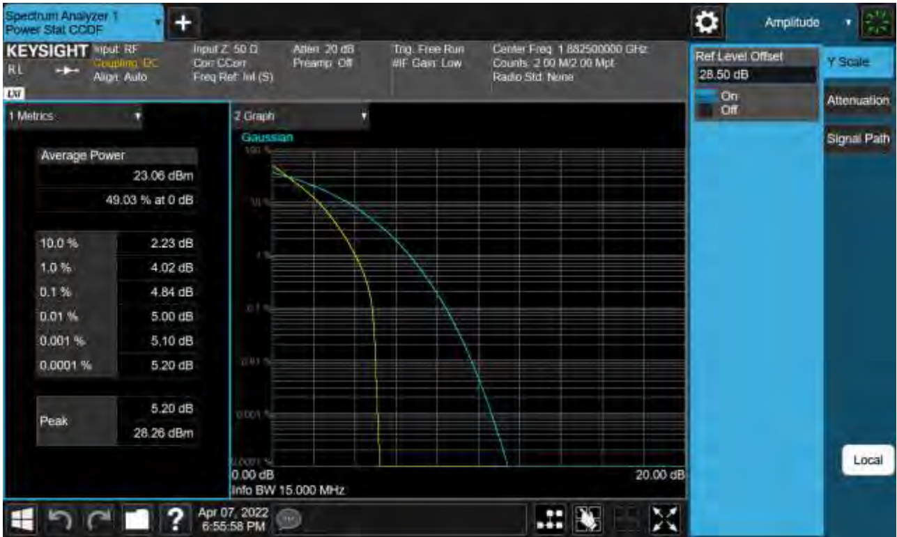
Sub6 n25(2). PAR Plot (15 M BW Ch.376500 QPSK _ Full RB _0)
