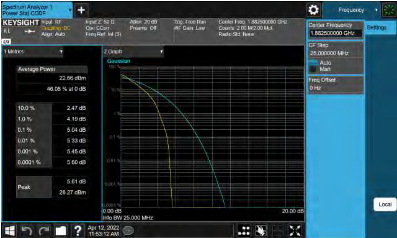
Sub6 n25. PAR Plot (25 M BW Ch.376500 QPSK _ Full RB _0)
