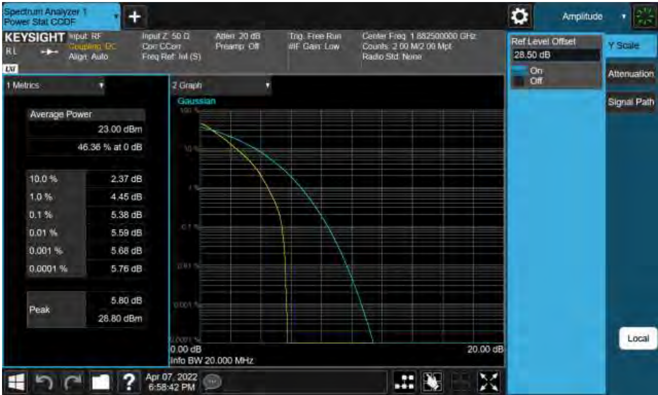
Sub6 n25(2). PAR Plot (20 M BW Ch.376500 QPSK_ Full RB _0)
