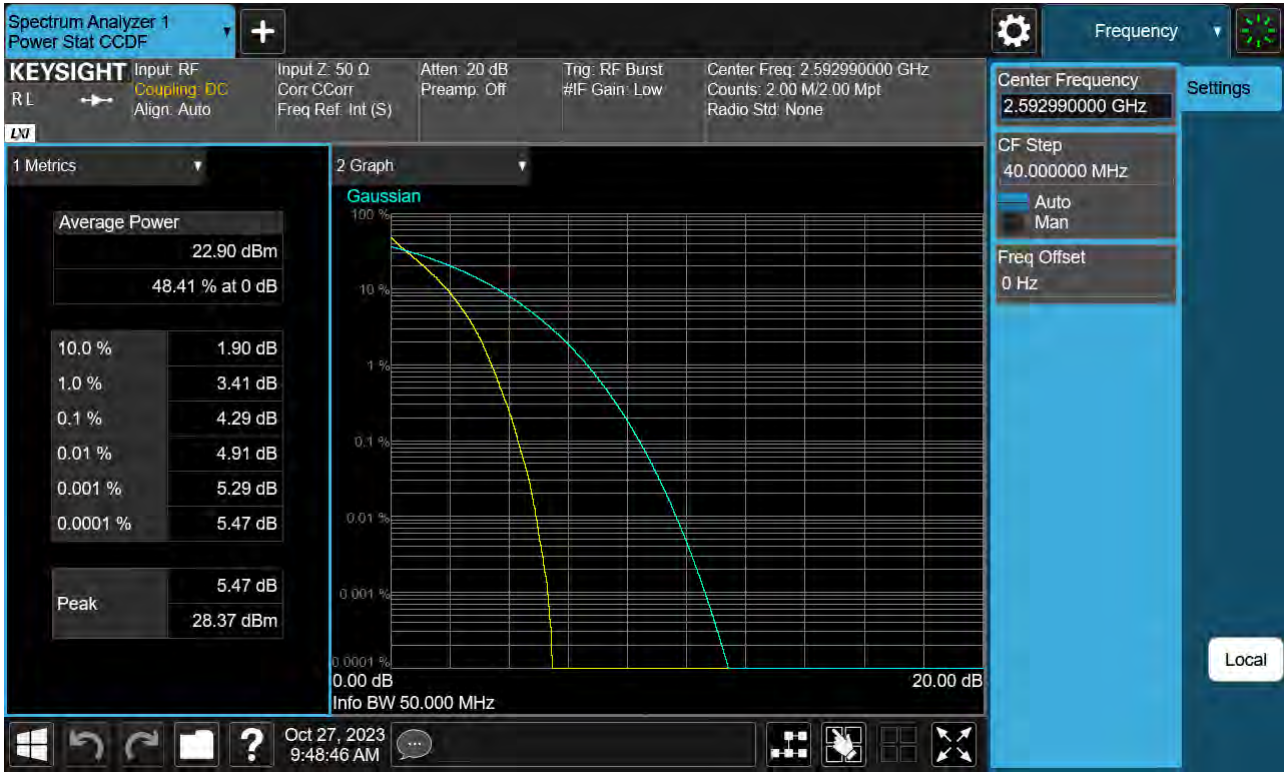
Sub6 n41. PAR Plot (50 M BW_Ch.518598_BPSK)
