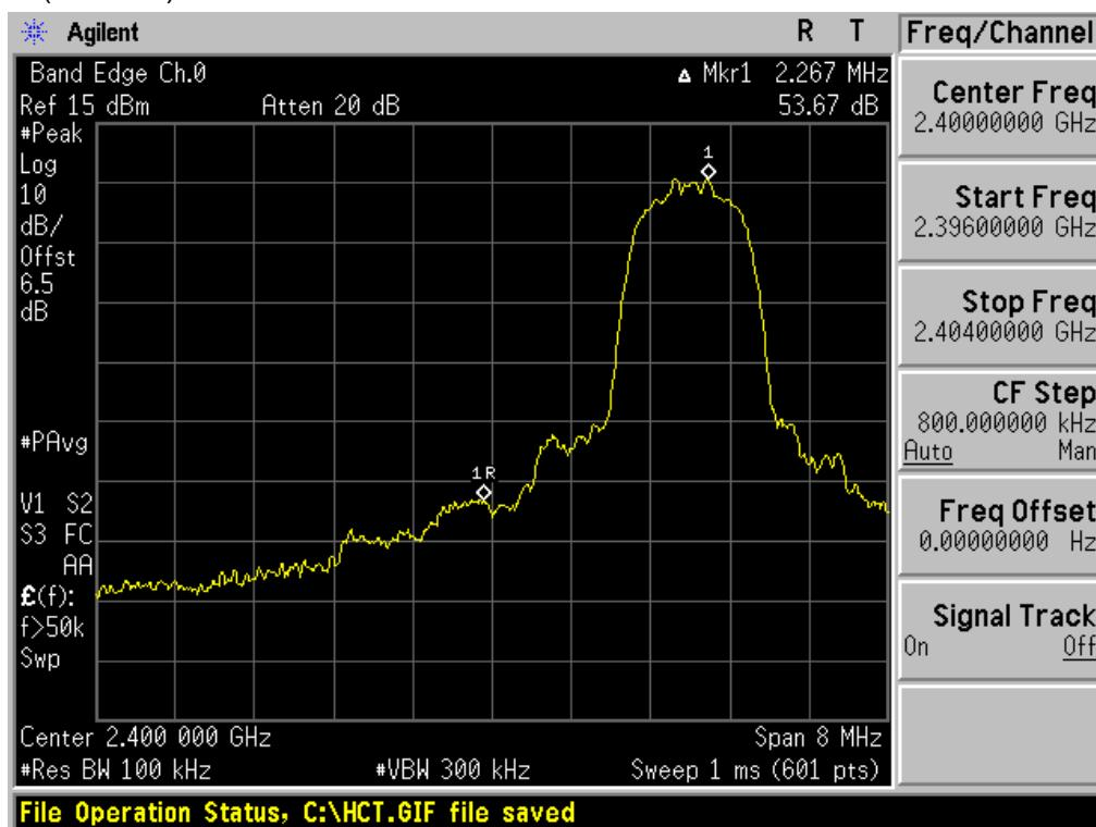
Test Plots without hopping ( $\pi/4$ DQPSK)
