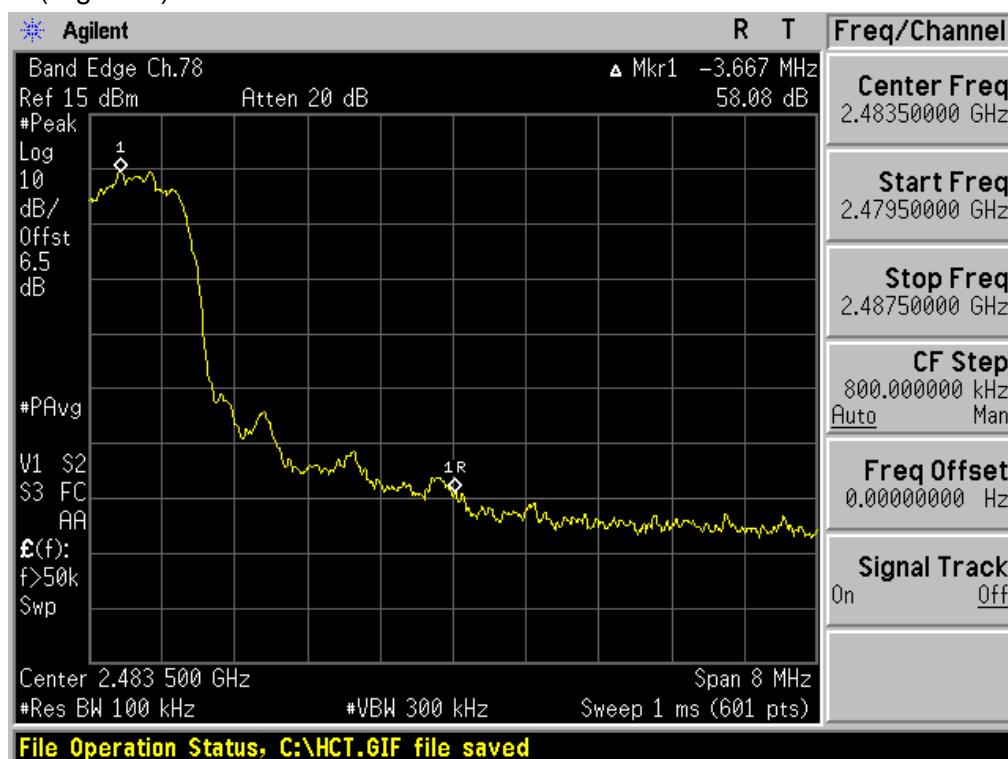
Test Plots without hopping ( $\pi/4$ DQPSK)
