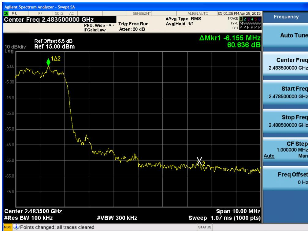
Test Plots with hopping ( $\pi/4$ DQPSK)
