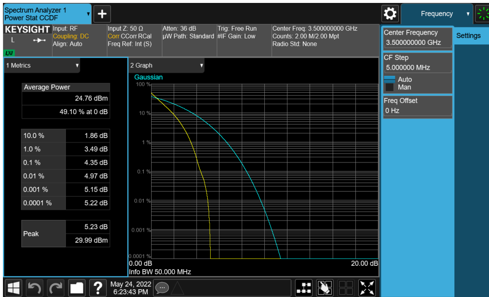
Plot 7-376. PAR Plot (NR Band n77 (DoD) - 50MHz DFT-s-OFDM BPSK - Full RB - Ant F)
