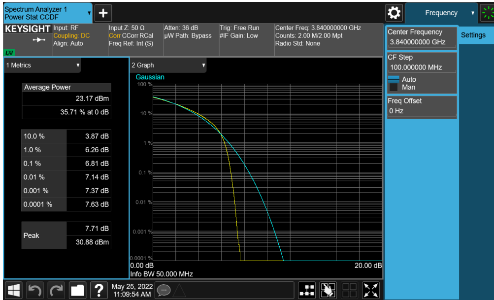
Plot 7-305. PAR Plot (NR Band n77 (C-Band) - 50MHz CP-OFDM QPSK - Full RB - Ant F)
