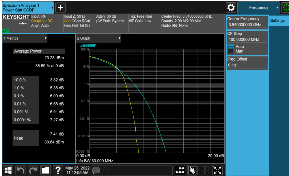
Plot 7-311. PAR Plot (NR Band n77 (C-Band) - 30MHz CP-OFDM QPSK - Full RB - Ant F)
