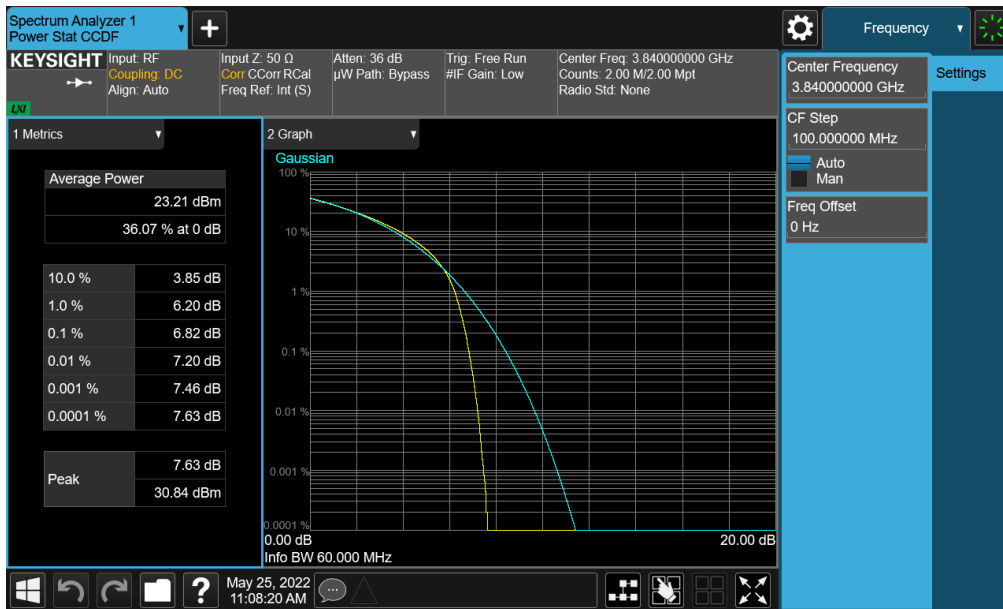
Plot 7-302. PAR Plot (NR Band n77 (C-Band) - 60MHz CP-OFDM QPSK - Full RB - Ant F)
