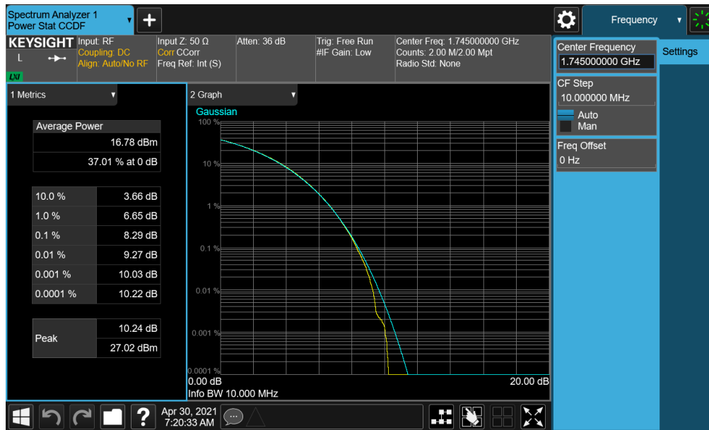
Plot 7-171. PAR Plot (NR Band n66 - 10.0MHz CP-OFDM 256-QAM - Full RB)
