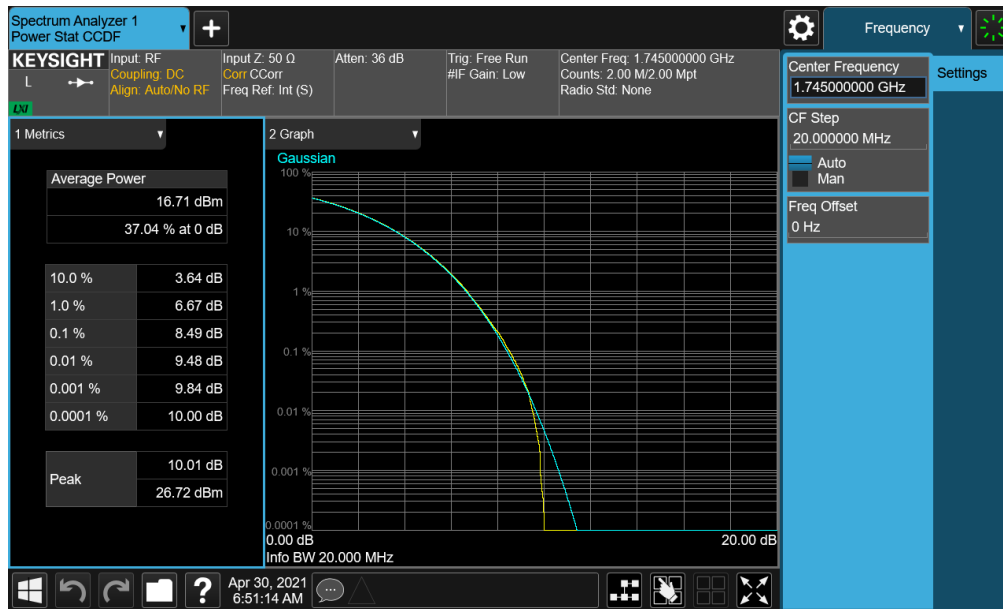
Plot 7-165. PAR Plot (NR Band n66 - 20.0MHz CP-OFDM 256-QAM - Full RB)
