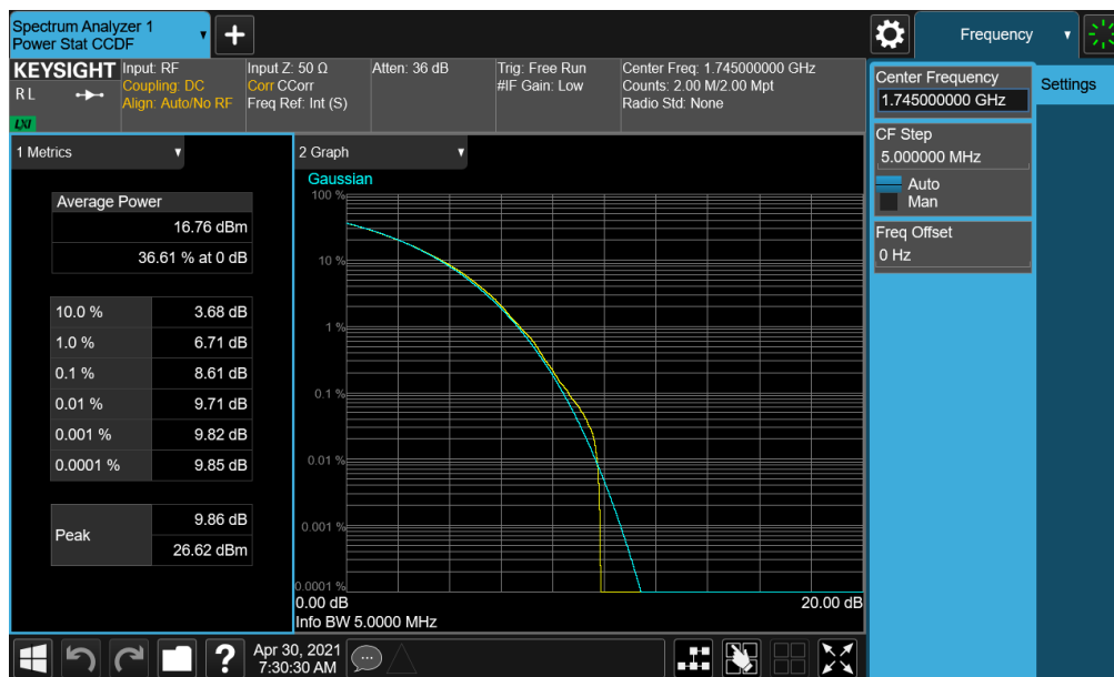
Plot 7-174. PAR Plot (NR Band n66 - 5.0MHz CP-OFDM 256-QAM - Full RB)
