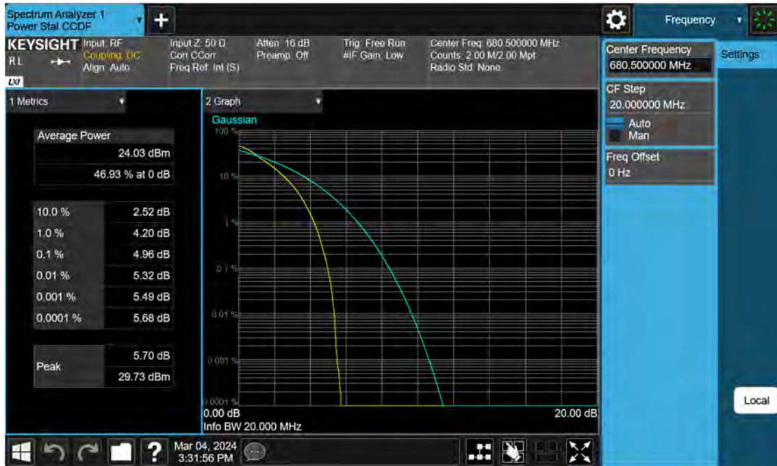
Sub6 n71. PAR Plot (20 M BW_Ch.349000_QPSK_Full RB)
