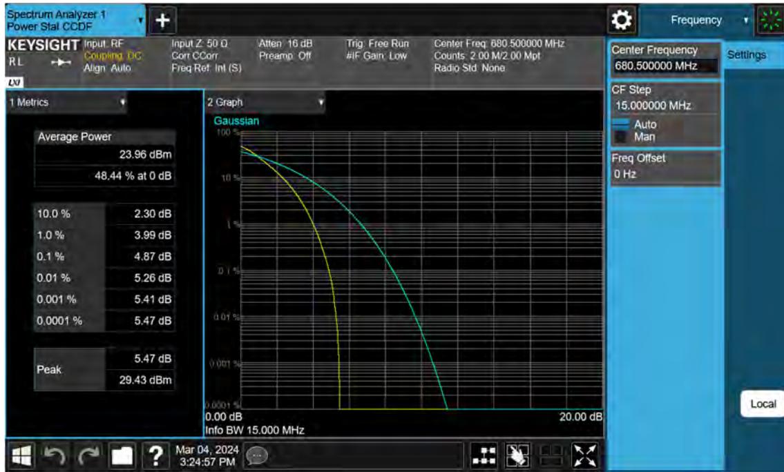
Sub6 n71. PAR Plot (15 M BW_Ch.349000_QPSK_Full RB)
