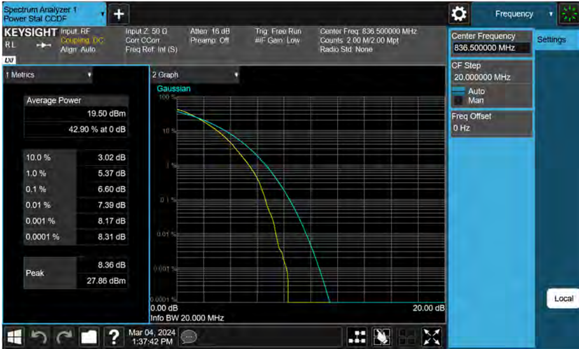
Sub6 n26. PAR Plot (20 M BW Ch.167300 256QAM RB 100_0)
