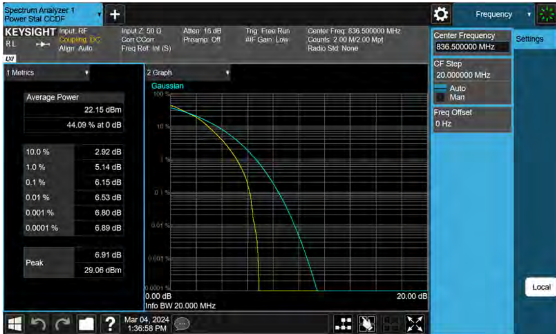
Sub6 n26. PAR Plot (20 M BW Ch.167300 16QAM RB 100_0)
