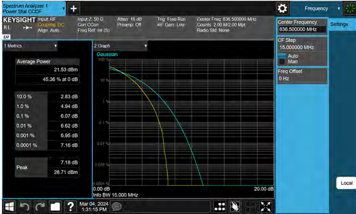
Sub6 n26. PAR Plot (15 M BW Ch.167300 64QAM RB 75_0)
