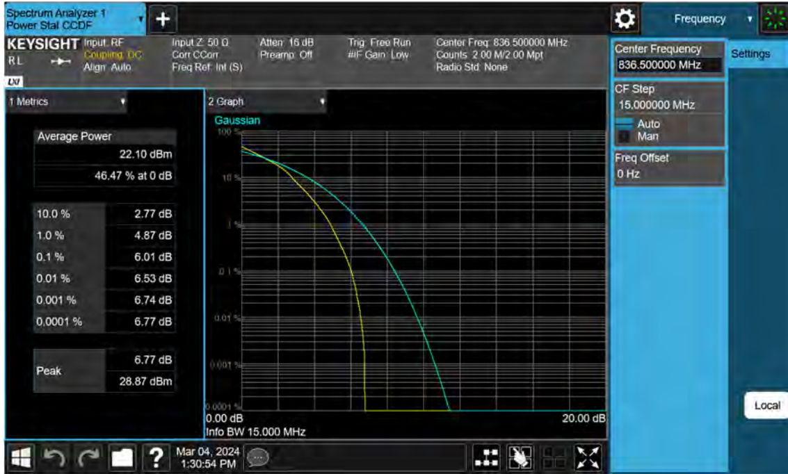
Sub6 n26. PAR Plot (15 M BW Ch.167300 16QAM RB 75_0)
