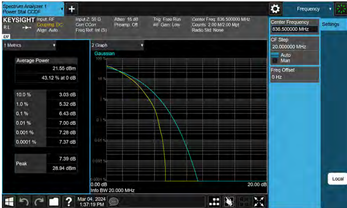
Sub6 n26. PAR Plot (20 M BW Ch.167300 64QAM RB 100_0)
