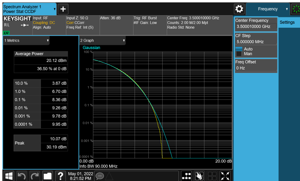
Plot 7-176. PAR Plot (NR Band n77 - DoD Band – 90MHz CP-OFDM 256-QAM - Full RB)
