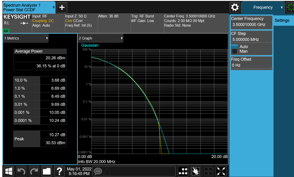
Plot 7-197. PAR Plot (NR Band n77 - DoD Band – 20MHz CP-OFDM 256-QAM - Full RB)
