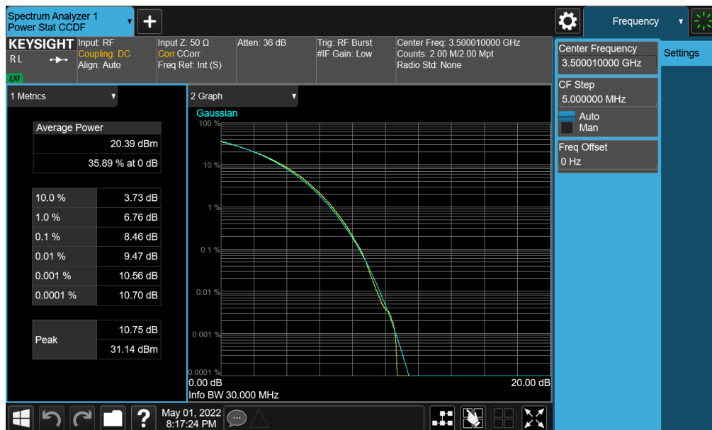
Plot 7-194. PAR Plot (NR Band n77 - DoD Band – 30MHz CP-OFDM 256-QAM - Full RB)
