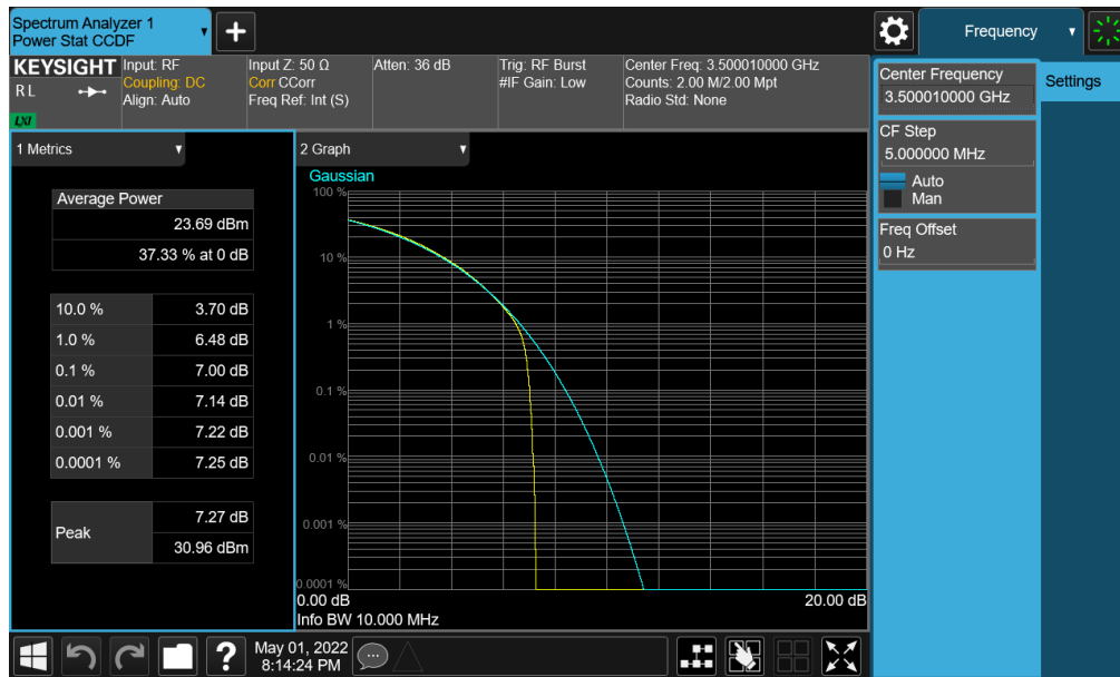
Plot 7-202. PAR Plot (NR Band n77 - DoD Band – 10MHz CP-OFDM QPSK - Full RB)
