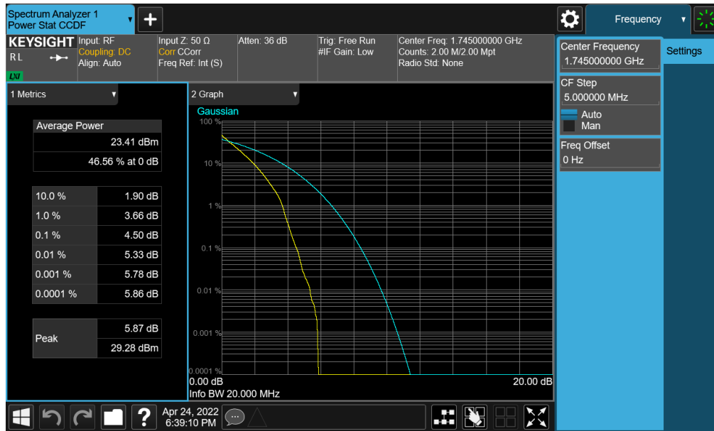
Plot 7-345. PAR Plot (NR Band n66 - 20.0MHz DFT-s-OFDM BPSK - Full RB)
