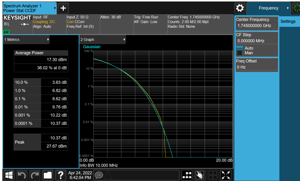
Plot 7-353. PAR Plot (NR Band n66 - 10.0MHz CP-OFDM 256-QAM - Full RB)
