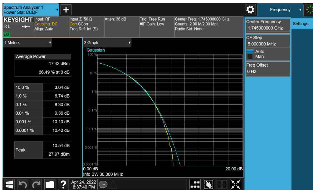
Plot 7-344. PAR Plot (NR Band n66 - 30.0MHz CP-OFDM 256-QAM - Full RB)
