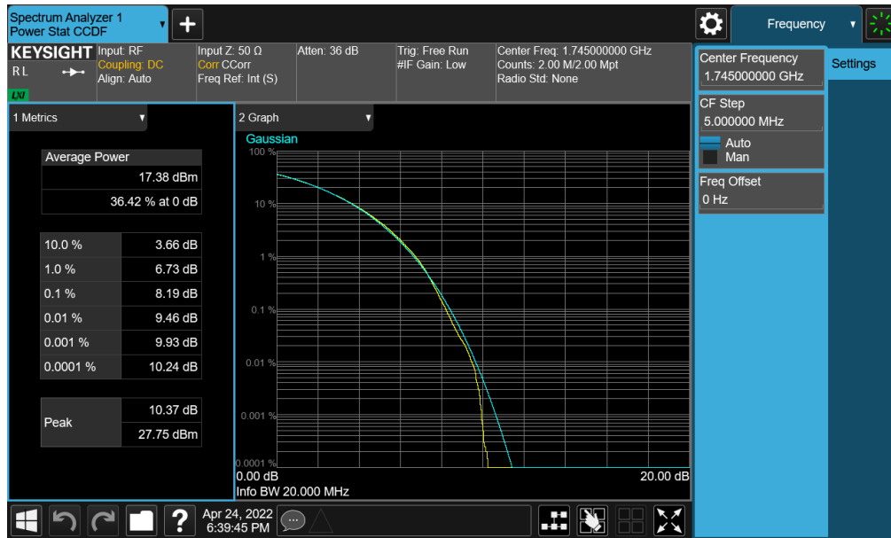
Plot 7-347. PAR Plot (NR Band n66 - 20.0MHz CP-OFDM 256-QAM - Full RB)
