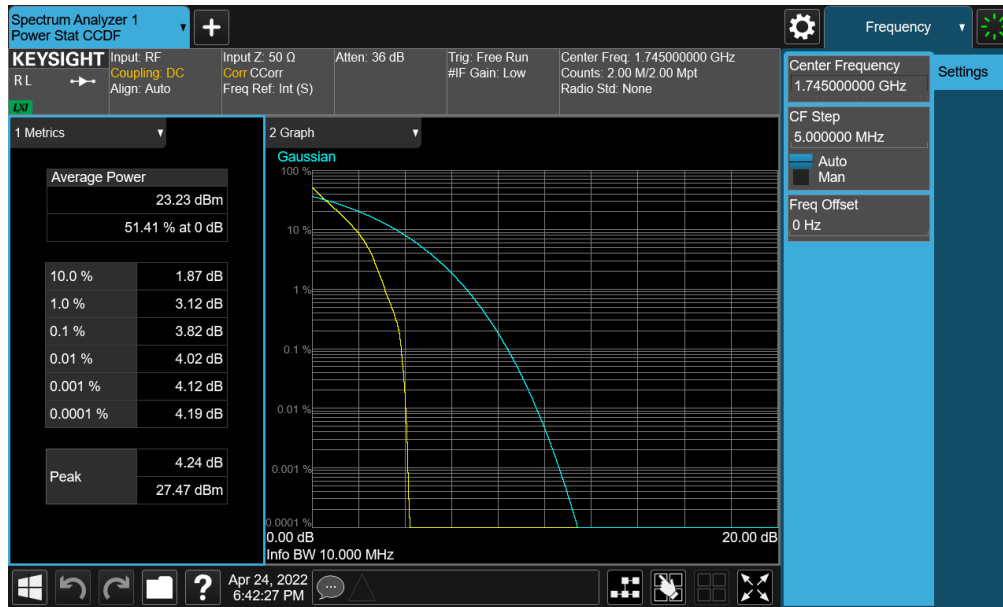
Plot 7-351. PAR Plot (NR Band n66 - 10.0MHz DFT-s-OFDM BPSK - Full RB)
