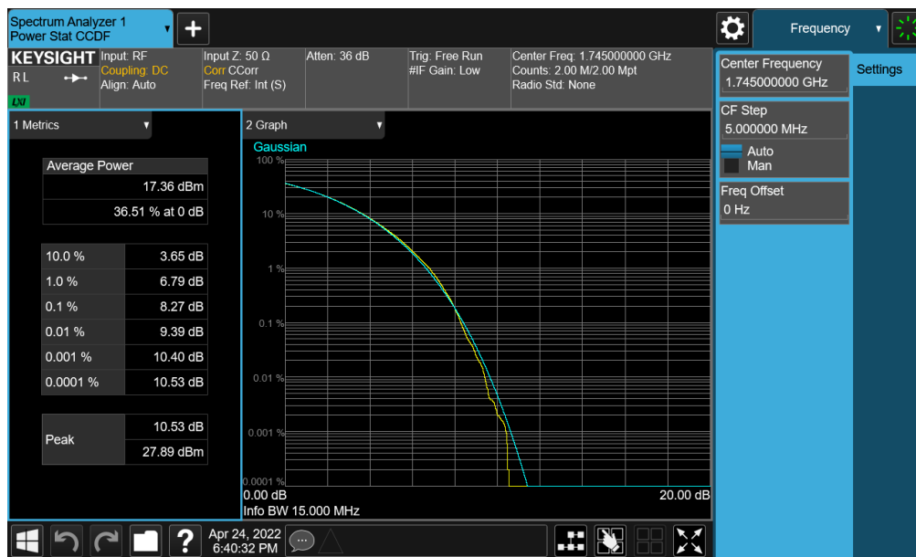
Plot 7-350. PAR Plot (NR Band n66 - 15.0MHz CP-OFDM 256-QAM - Full RB)
