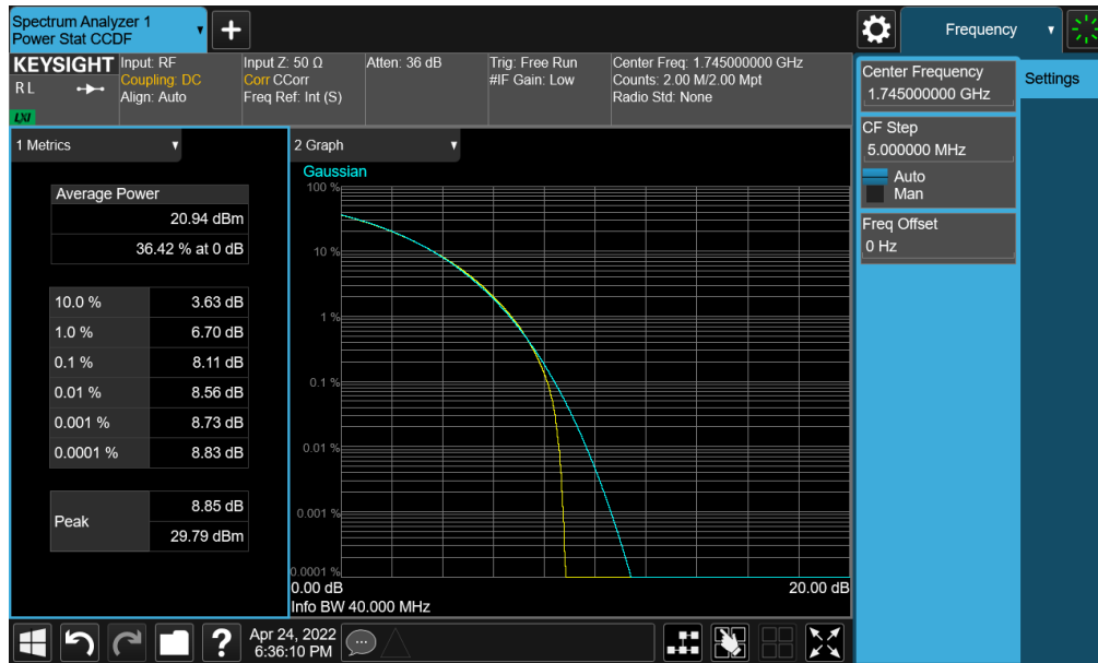
Plot 7-340. PAR Plot (NR Band n66 - 40.0MHz CP-OFDM QPSK - Full RB)
