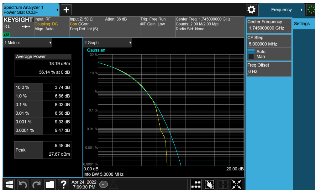
Plot 7-338. PAR Plot (NR Band n66 - 5.0MHz CP-OFDM 256-QAM - Full RB)
