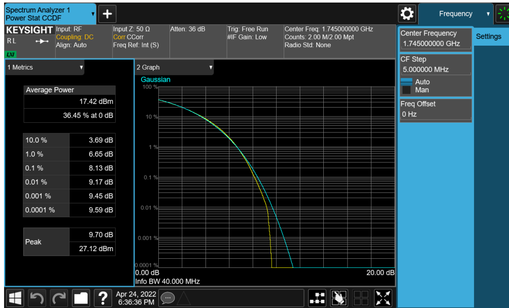
Plot 7-341. PAR Plot (NR Band n66 - 40.0MHz CP-OFDM 256-QAM - Full RB)
