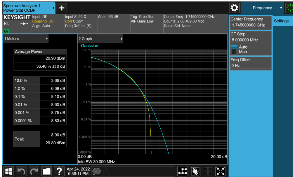
Plot 7-343. PAR Plot (NR Band n66 - 30.0MHz CP-OFDM QPSK - Full RB)
