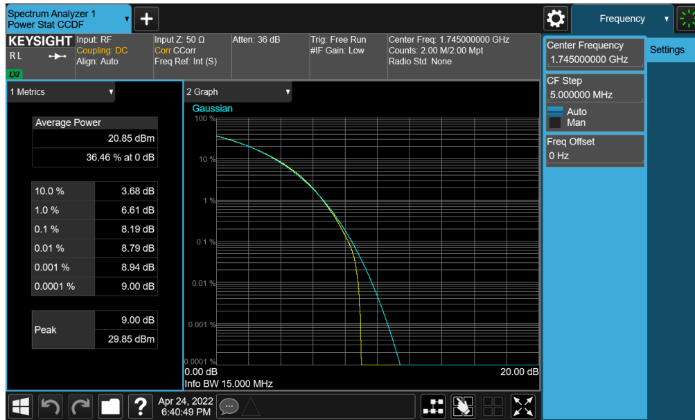
Plot 7-349. PAR Plot (NR Band n66 - 15.0MHz CP-OFDM QPSK - Full RB)
