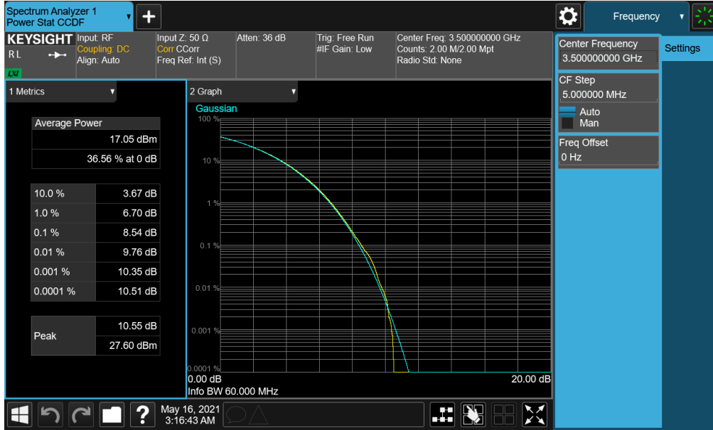
Plot 7-192. PAR Plot (NR Band n77 PC2 - 60MHz CP-OFDM 256-QAM - Full RB)
