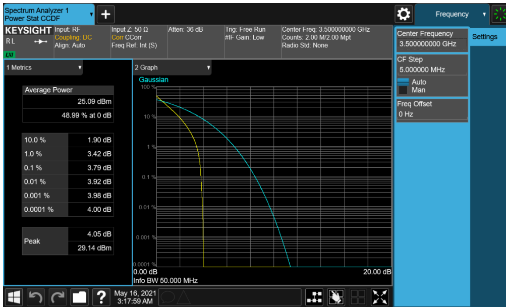
Plot 7-193. PAR Plot (NR Band n77 PC2 - 50MHz \pi/2 BPSK - Full RB)
