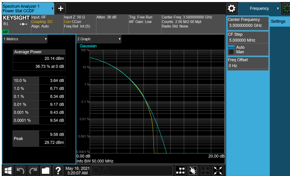
Plot 7-195. PAR Plot (NR Band n77 PC2 - 50MHz CP-OFDM 256-QAM - Full RB)
