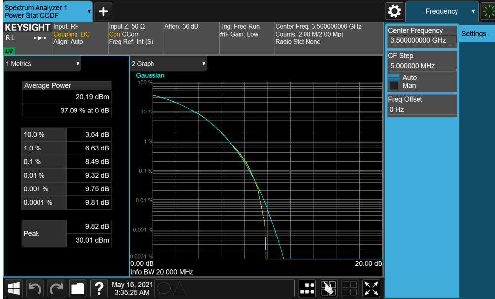
Plot 7-204. PAR Plot (NR Band n77 PC2 - 20MHz CP-OFDM 256-QAM - Full RB)
