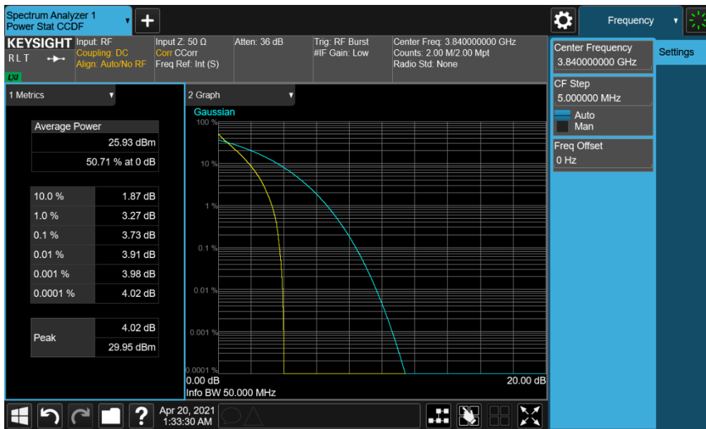
Plot 7-166. PAR Plot (NR Band n77 PC2 - 50MHz \pi/2 BPSK - Full RB)
