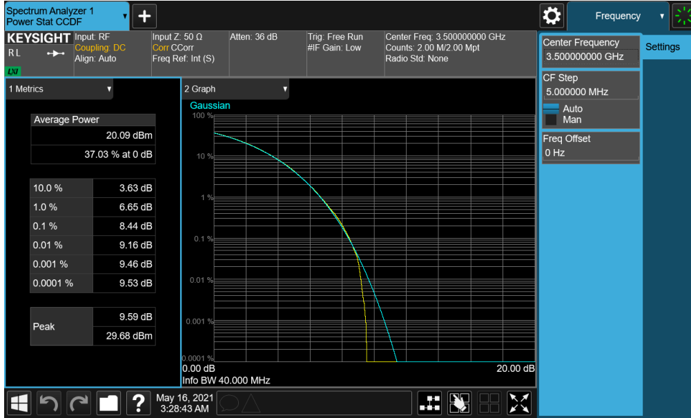
Plot 7-198. PAR Plot (NR Band n77 PC2 - 40MHz CP-OFDM 256-QAM - Full RB)
