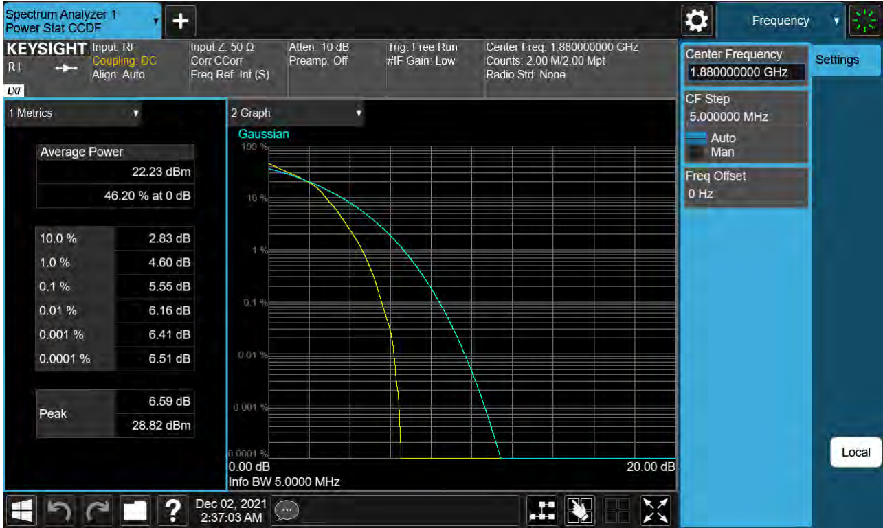
Sub6 n2. PAR Plot (5 M BW Ch.376000 16QAM RB 25_0)
