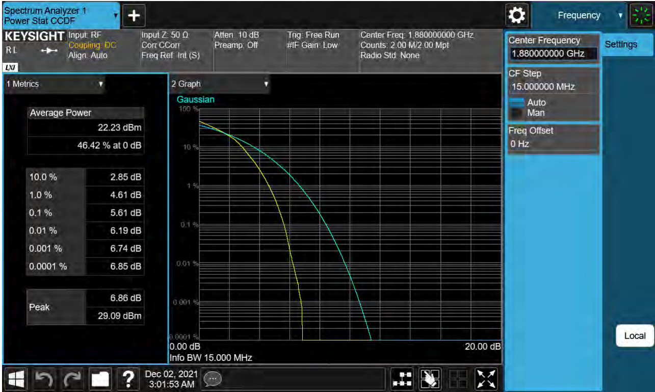
Sub6 n2. PAR Plot (15 M BW Ch.376000 16QAM RB 75_0)
