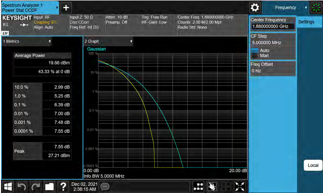
Sub6 n2. PAR Plot (5 M BW Ch.376000 256QAM RB 25_0)
