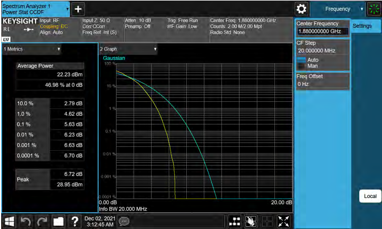
Sub6 n2. PAR Plot (20 M BW Ch.376000 16QAM RB 100_0)
