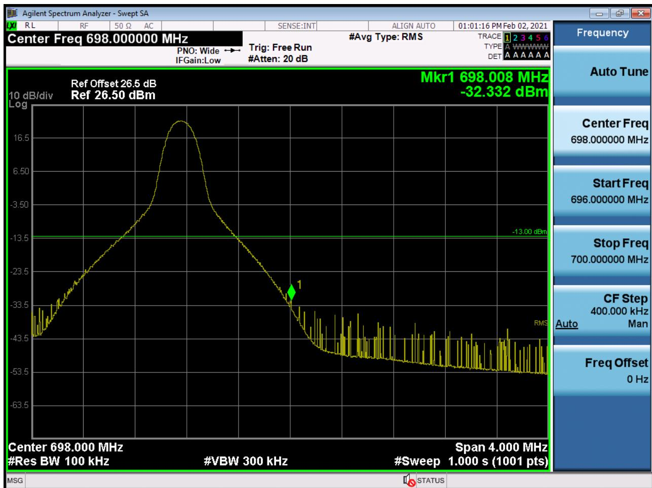
BAND 71. Upper Band Edge Plot (15M BW Ch.133397 QPSK\_RB25\_Offset 0)
