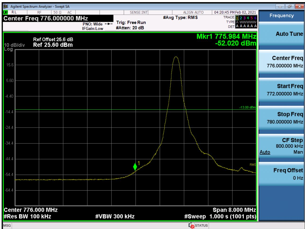
Band 13 Lower Band Edge Plot (5M BW Ch.23205 QPSK\_RB\_25\_0)-1
