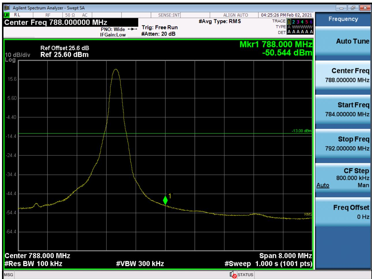
Band 13 Upper Band Edge Plot (5M BW Ch.23255 QPSK\_RB\_25\_0)-1
