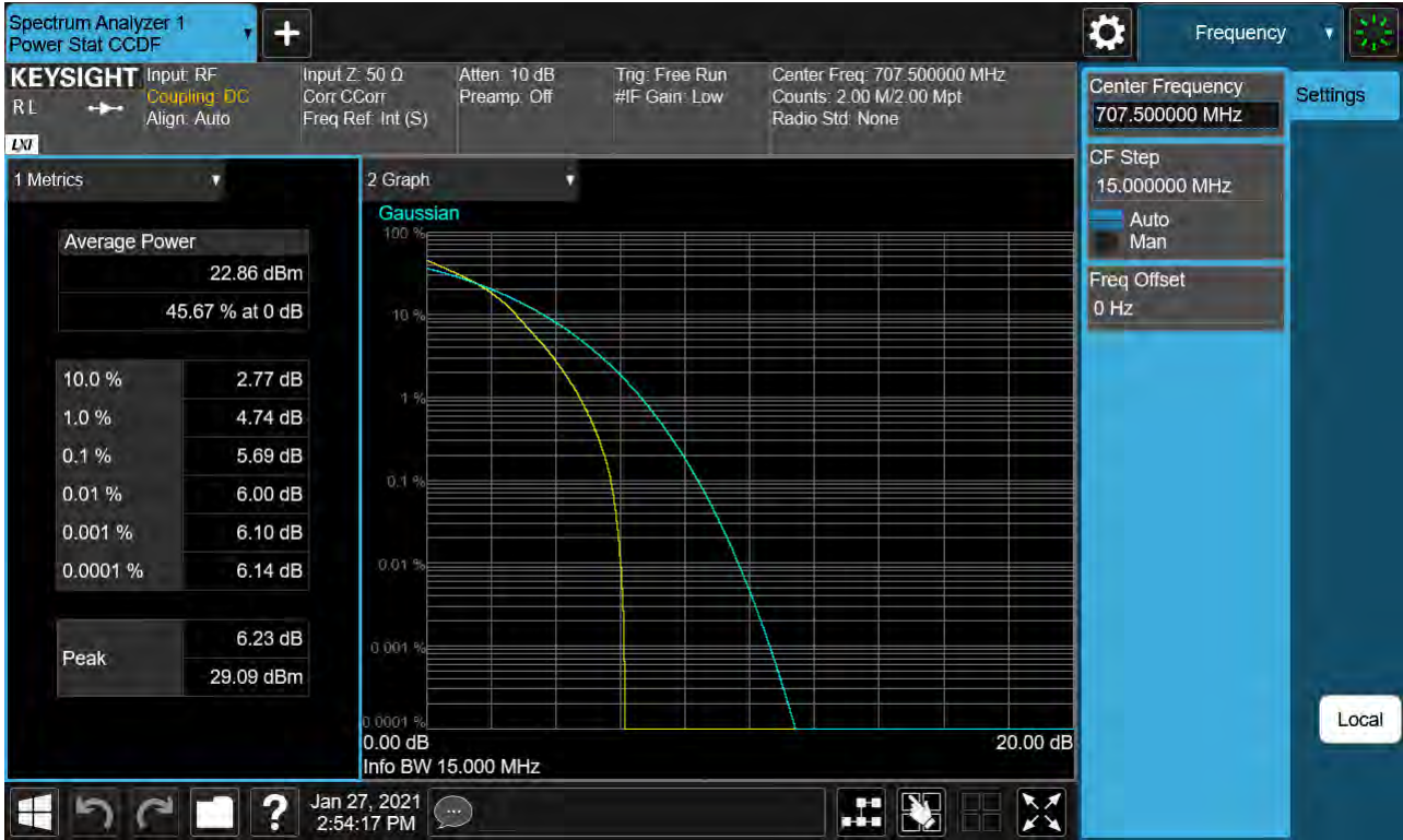
Sub6 n12. PAR Plot (15M BW Ch.141500 16QAM_RB79_0)
