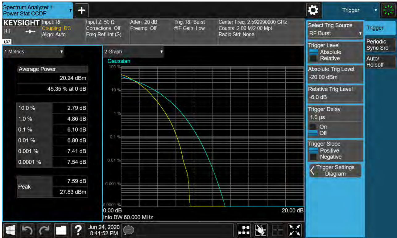
Sub6 n41. PAR Plot (60M BW_Ch.518598_64QAM_RB25_0)
