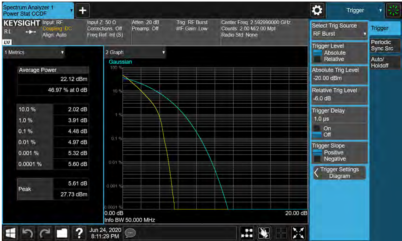
Sub6 n41. PAR Plot (50M BW_Ch.518598_BPSK_RB25_0)
