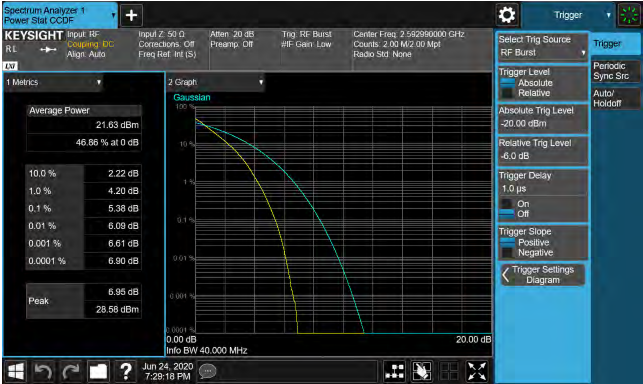
Sub6 n41. PAR Plot (40M BW_Ch.518598_QPSK_RB25_0)
