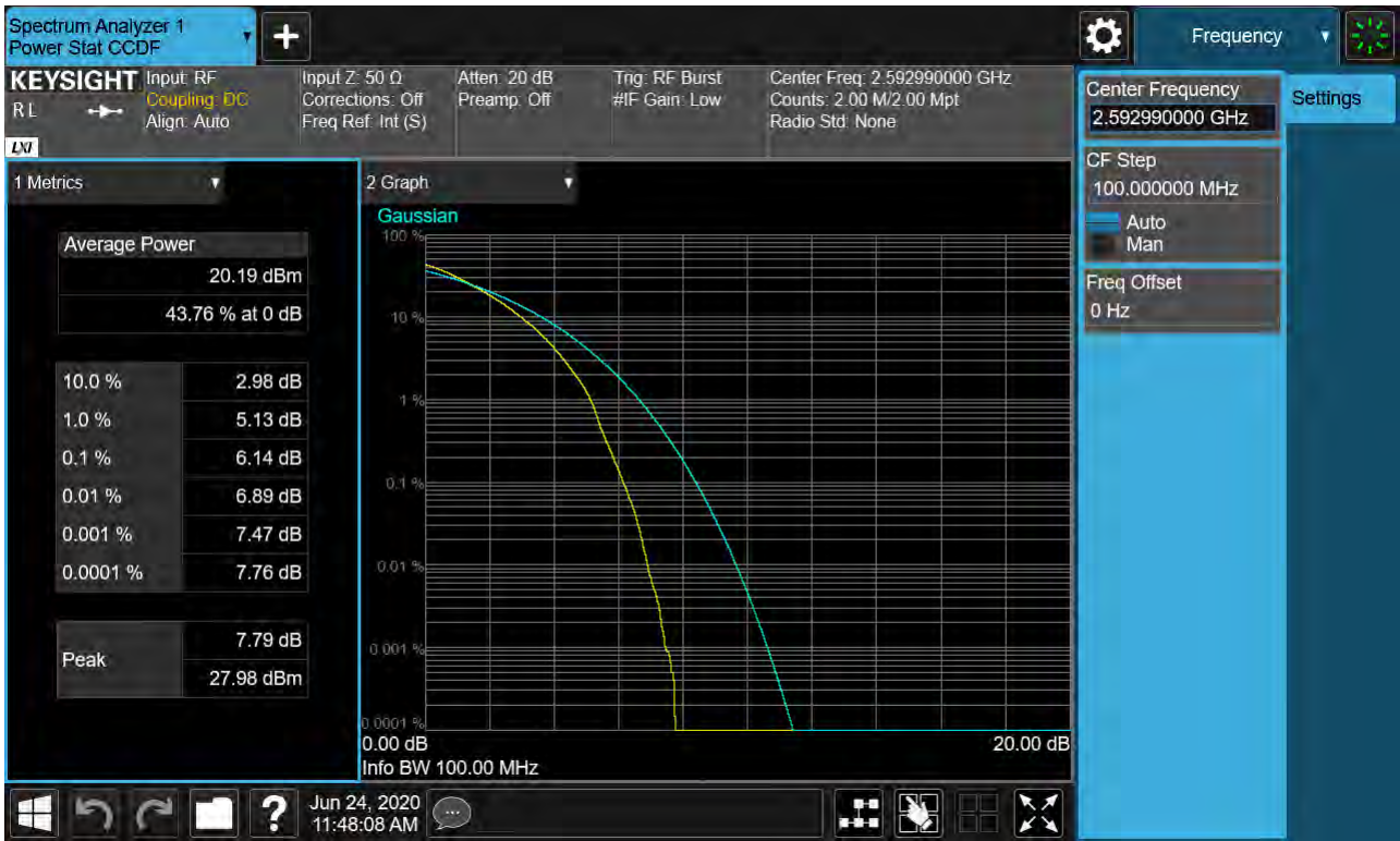
Sub6 n41. PAR Plot (100M BW_Ch.518598_64QAM_RB25_0)
