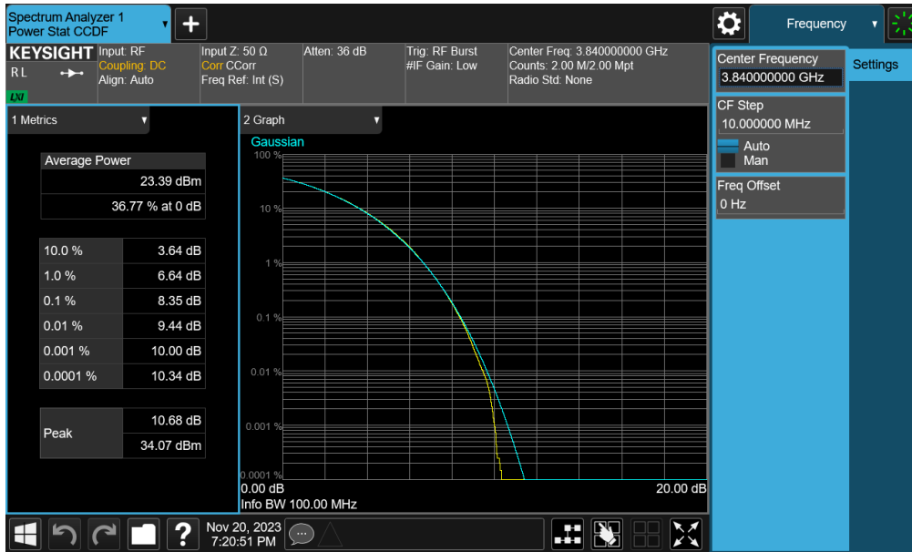
Plot 7-114. PAR Plot (NR Band n77/78 - 100MHz CP-OFDM QPSK - Full RB - Ant 1)
