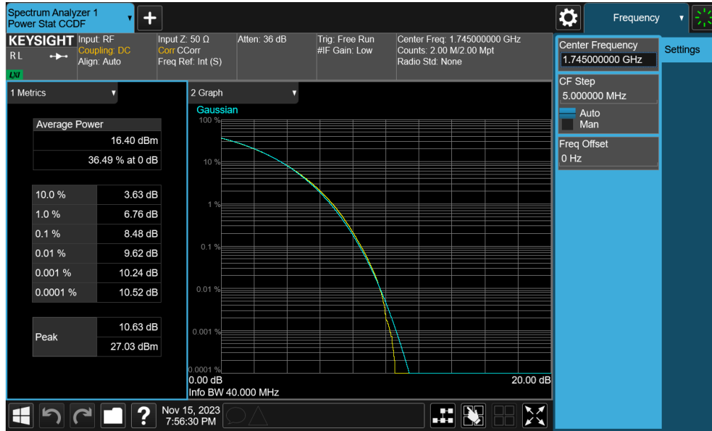
Plot 7-196. PAR Plot (NR Band n66 - 20.0MHz CP-OFDM 256-QAM - Full RB - ANT2)
