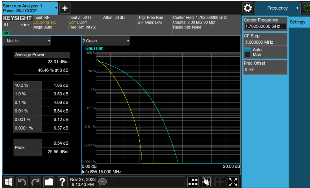
Plot 7-186. PAR Plot (NR Band n70 - 15.0MHz DFT-s-OFDM \pi/2 BPSK- Full RB - ANT1)
