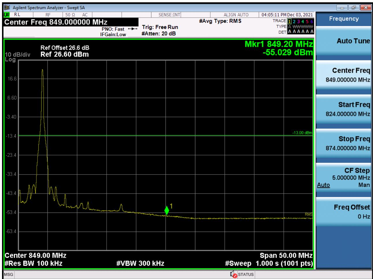
BAND 26. Mid Band Edge Plot (15 M BW Ch.26765 QPSK\_RB75\_Offset 0)
