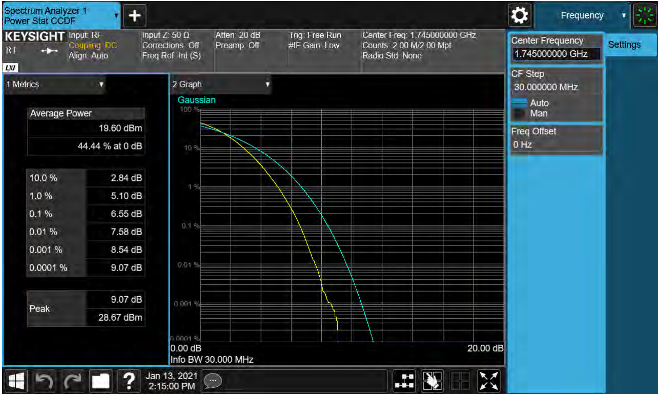
Sub6 n66. PAR Plot (30M BW_Ch.349000_256QAM_RB160_0)
