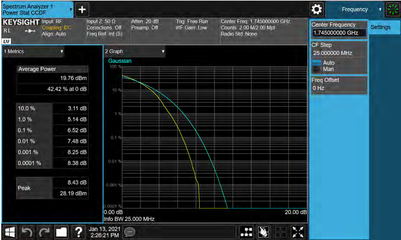
Sub6 n66. PAR Plot (25M BW_Ch.349000_256QAM_RB133_0)
