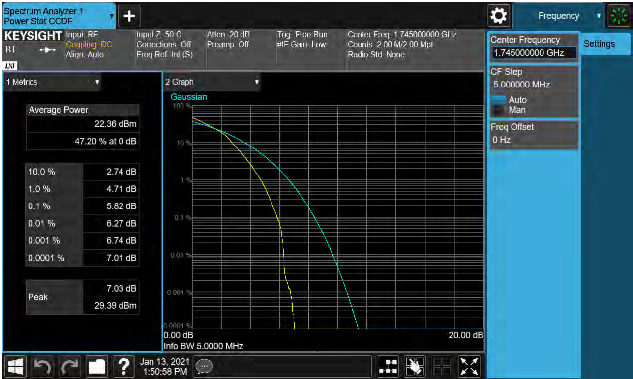
Sub6 n66. PAR Plot (5M BW_Ch.349000_16QAM_RB25_0)
