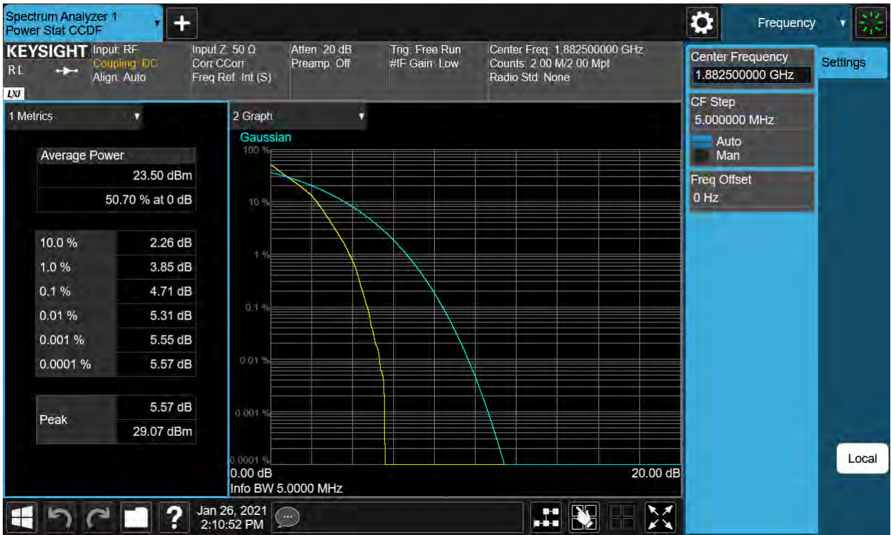
Sub6 n25. PAR Plot (5M BW Ch.376500 BPSK RB 25_0)
