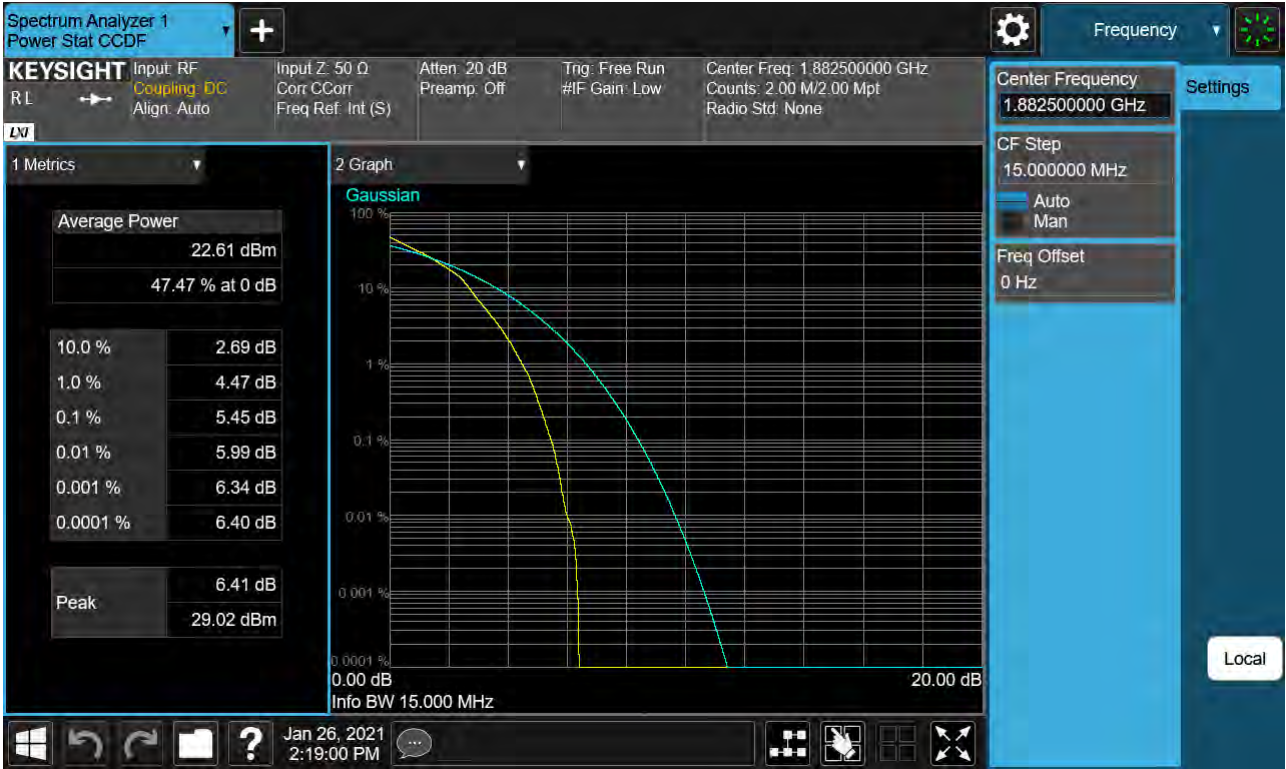
Sub6 n25. PAR Plot (15M BW Ch.376500 16QAM RB 79_0)
