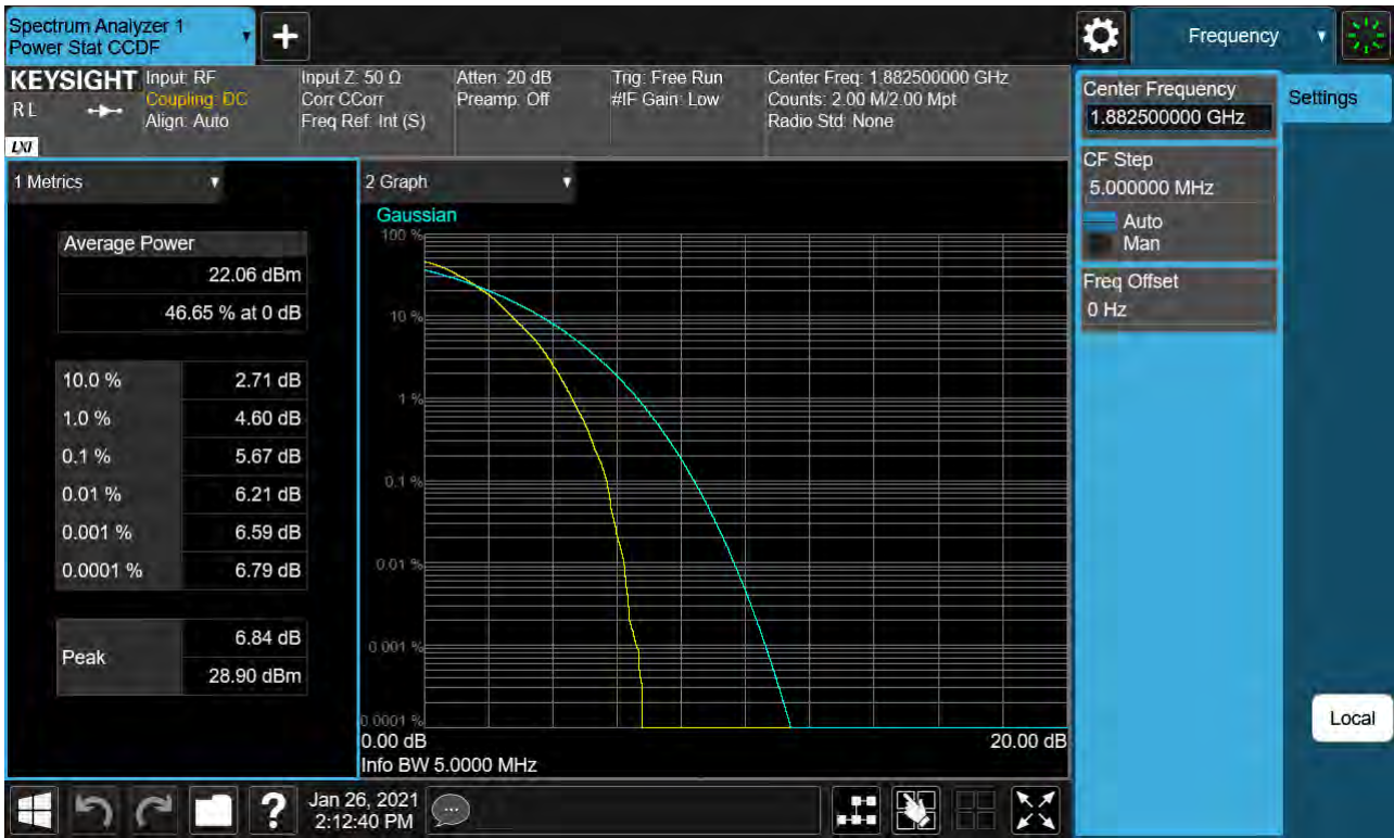
Sub6 n25. PAR Plot (5M BW Ch.376500 64QAM RB 25_0)
