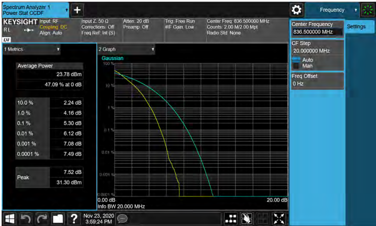
Sub6 n66. PAR Plot (20M BW_Ch.349000_QPSK_RB100_0)
