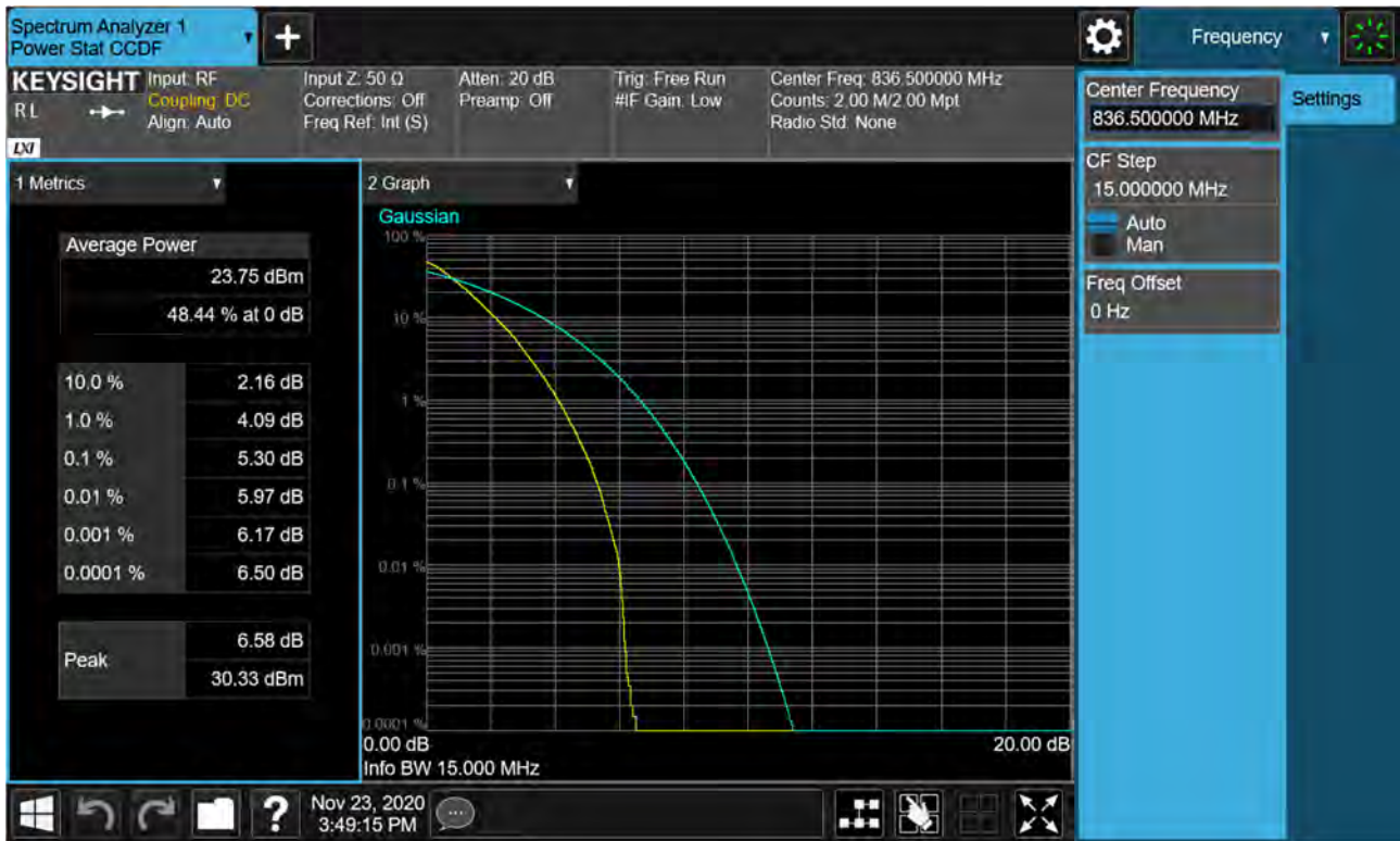
Sub6 n66. PAR Plot (15M BW_Ch.349000_QPSK_RB75_0)
