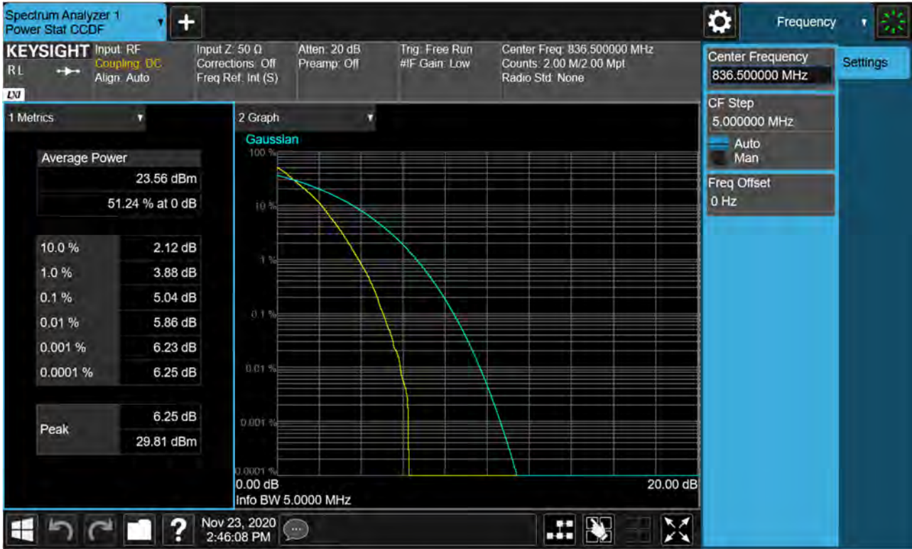
Sub6 n66. PAR Plot (5M BW_Ch.349000_QPSK_RB25_0)
