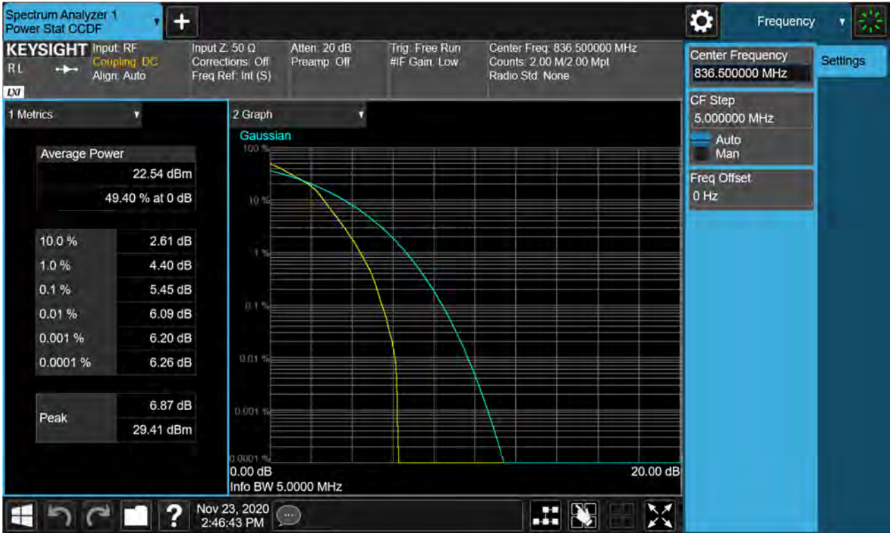
Sub6 n66. PAR Plot (5M BW_Ch.349000_16QAM_RB25_0)
