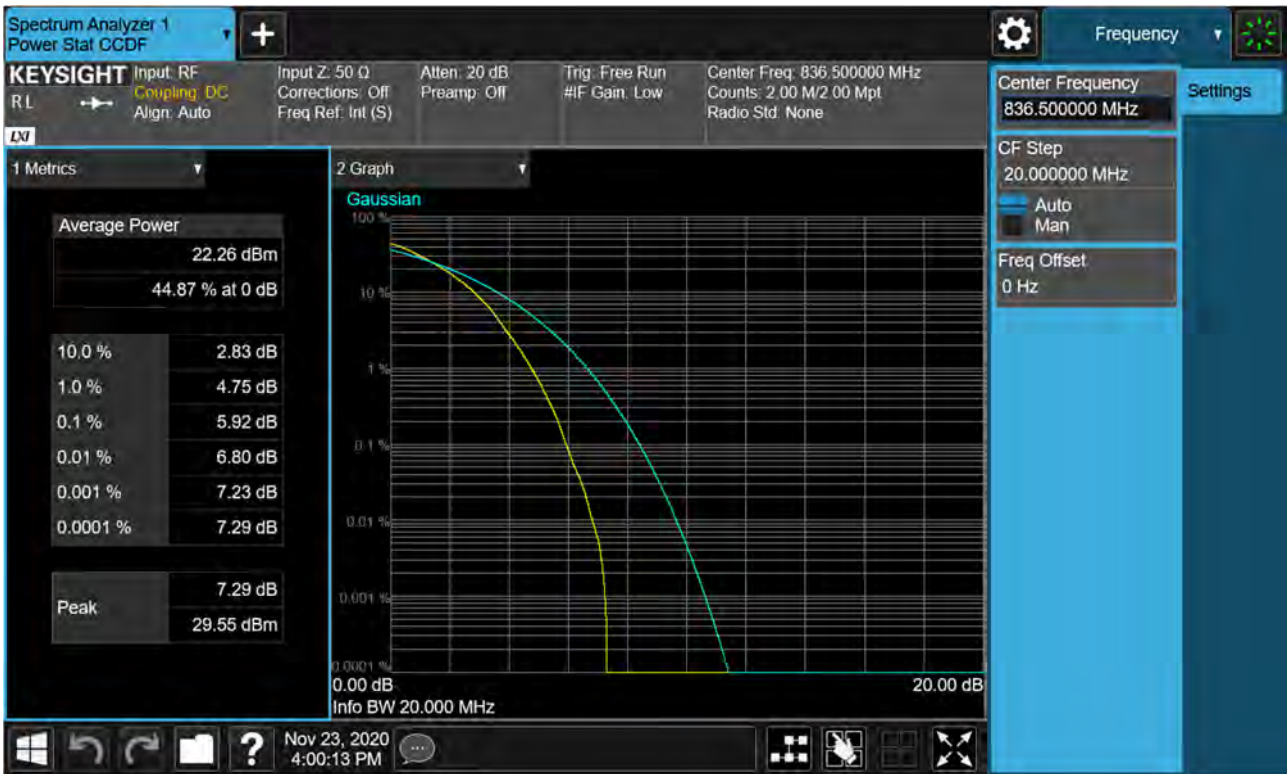
Sub6 n66. PAR Plot (20M BW_Ch.349000_64QAM_RB100_0)
