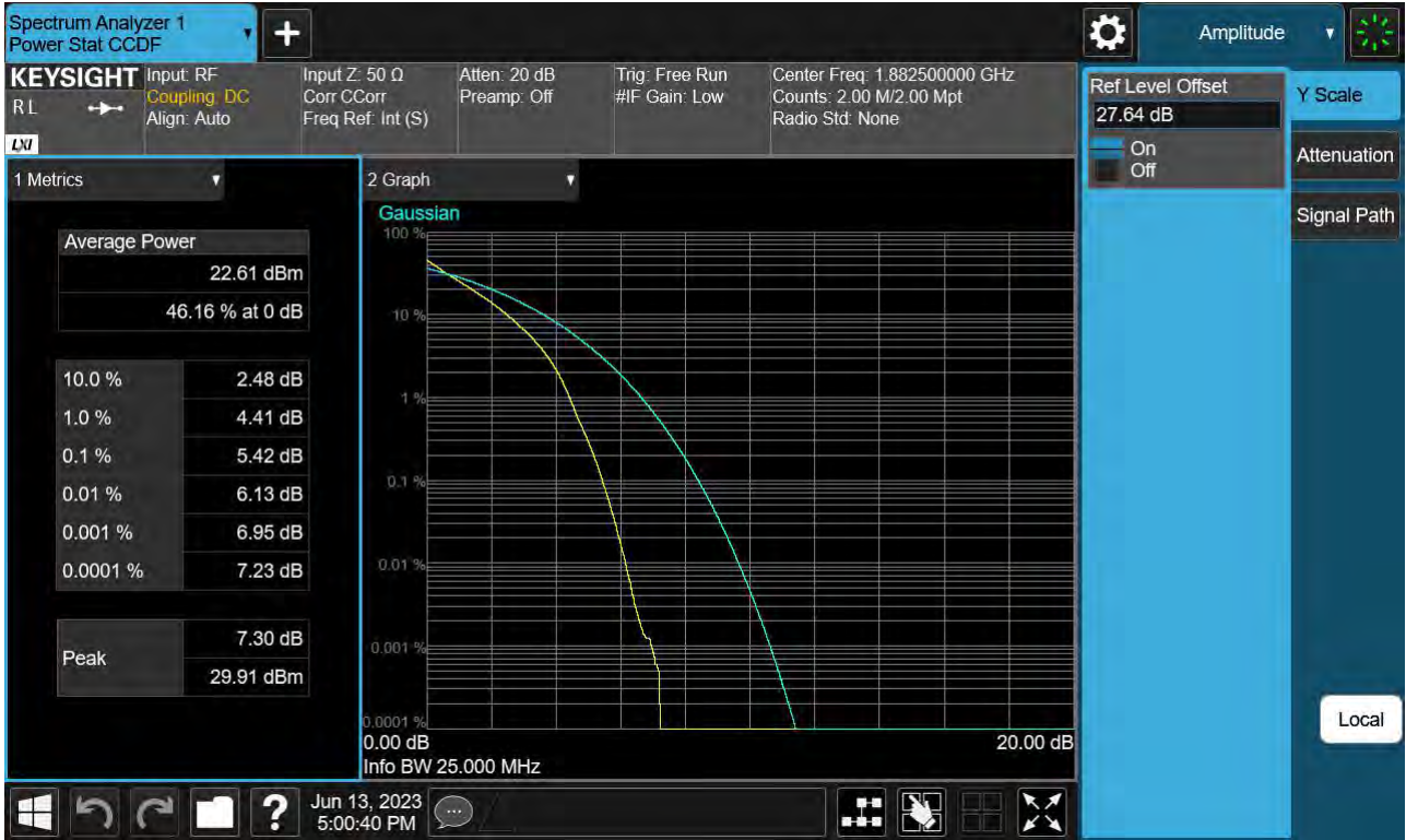
Sub6 n25(2). PAR Plot (25 M BW Ch.376500 QPSK _ Full RB _0)
