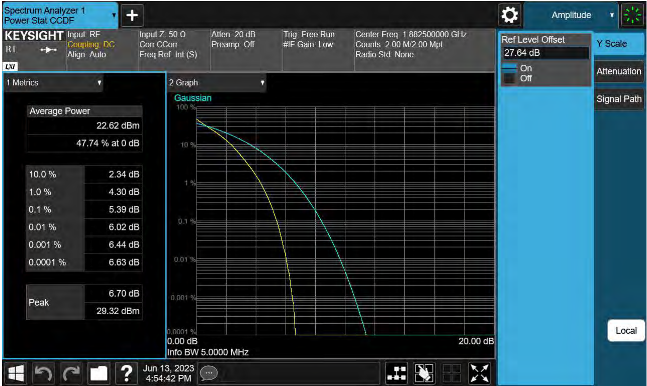
Sub6 n25(2). PAR Plot (5 M BW Ch.376500 QPSK _ Full RB _0)
