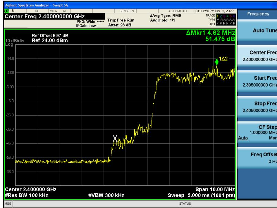
Test Plots with hopping ( $\pi/4$ DQPSK)
