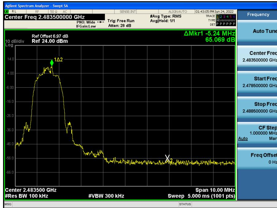
Test Plots without hopping ( $\pi/4$ DQPSK)
