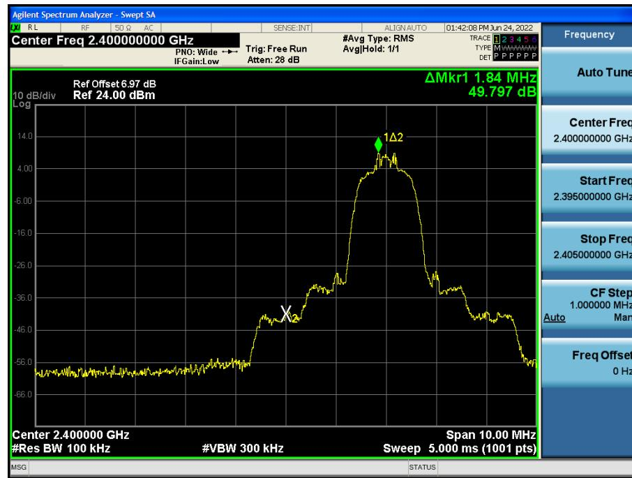
Test Plots without hopping ( $\pi/4$ DQPSK)
