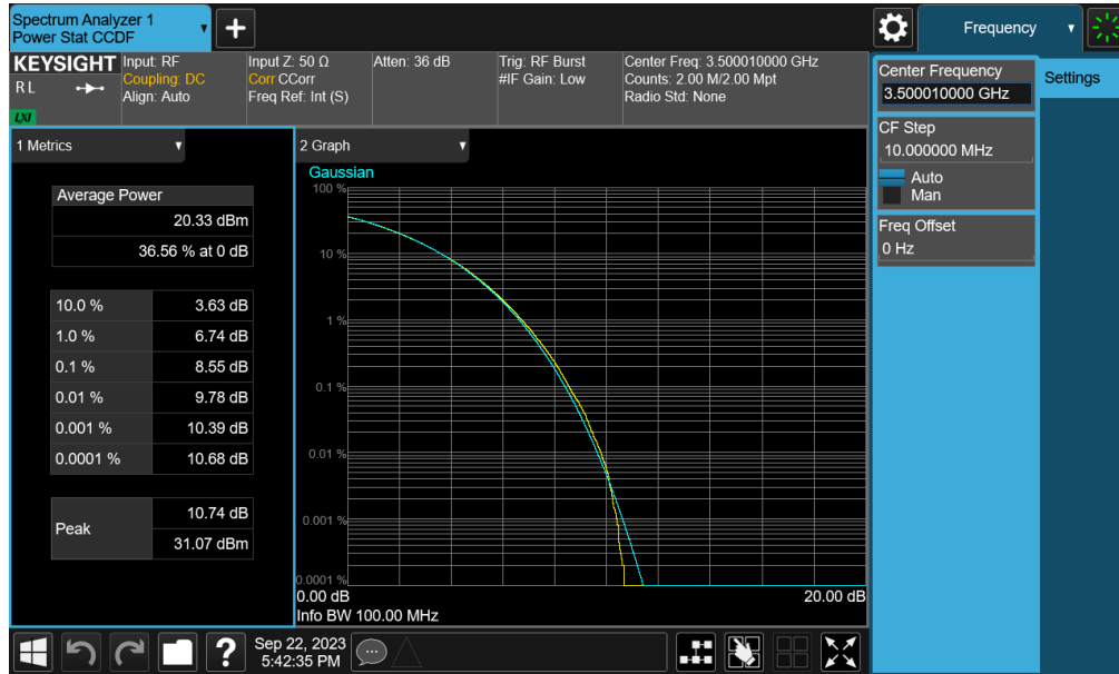
Plot 7-123. PAR Plot (NR Band n77 (DoD) - 100MHz CP-OFDM 256-QAM - Full RB - Ant1)
