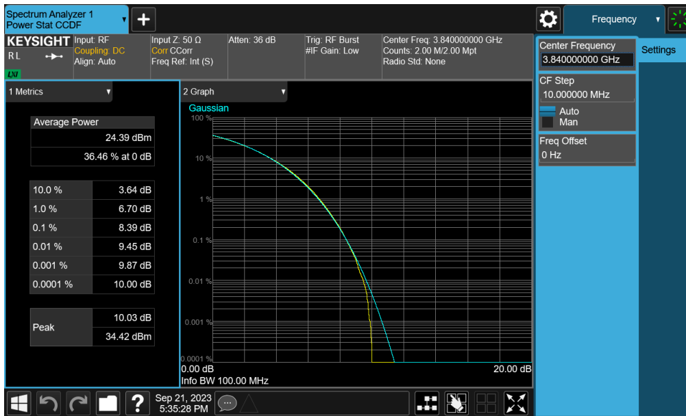
Plot 7-119. PAR Plot (NR Band n77 - 100MHz CP-OFDM QPSK - Full RB - Ant1)
