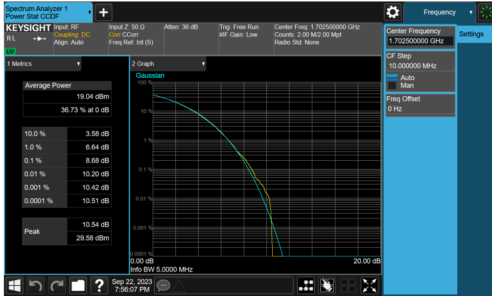
Plot 7-182. PAR Plot (NR Band n70 - 5.0MHz CP-OFDM 256-QAM - Full RB - ANT1)
