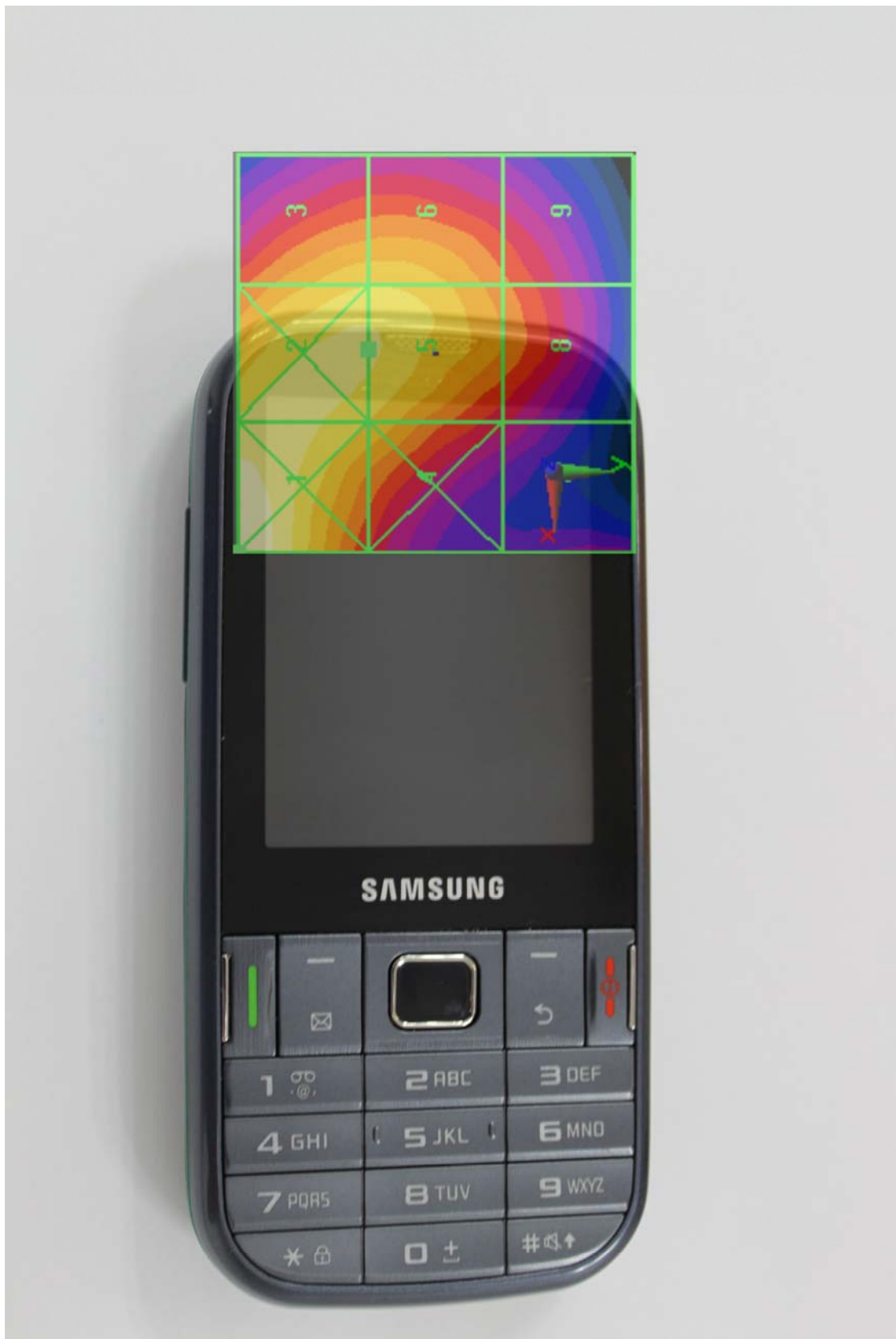
Scan overlay with actual device(H-field)
