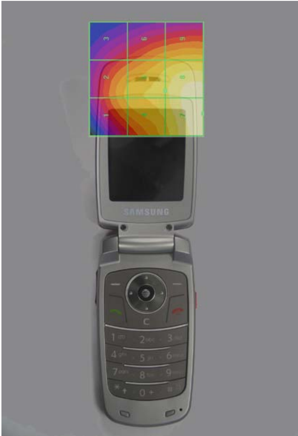
scan overlay with actual device(H-field)
