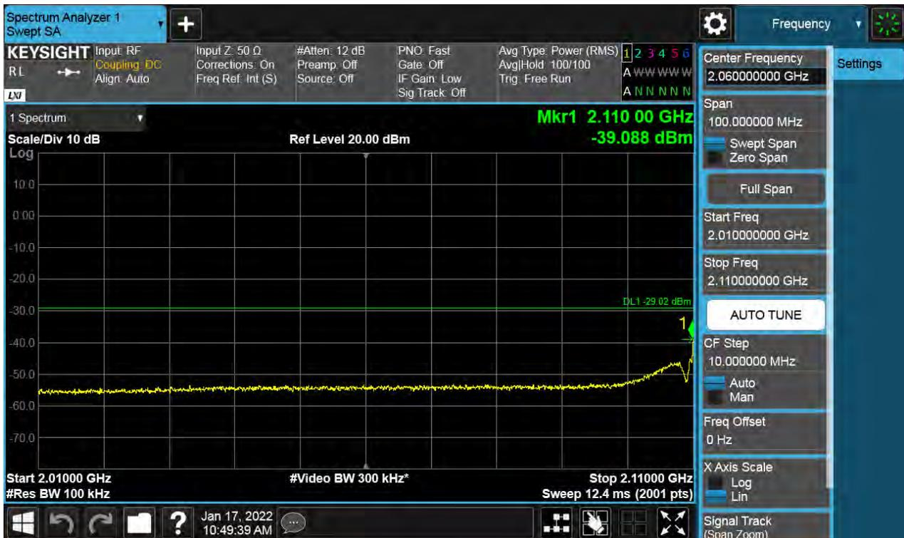
Antenna 3 / High Edge ~ High Edge + 100 MHz / (4 Port) 5G NR n66 20 MHz 1 Carrier / 64QAM / Low
