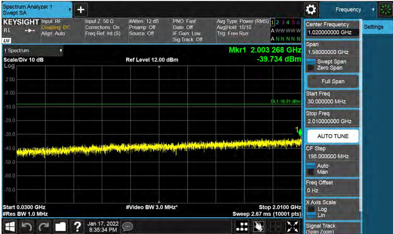
Antenna 0 / Low Edge - 100 MHz ~ Low Edge / (2 Port) 5G NR n66 20 MHz 1 Carrier / QPSK / Middle
