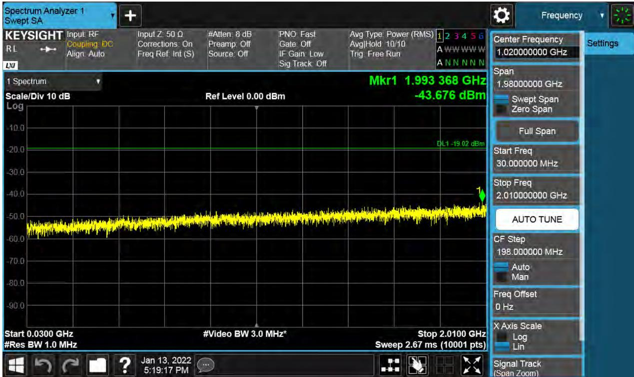
Antenna 0 / Low Edge - 100 MHz ~ Low Edge / (4 Port) 5G NR n66 5 MHz 1 Carrier / 64QAM / Middle
