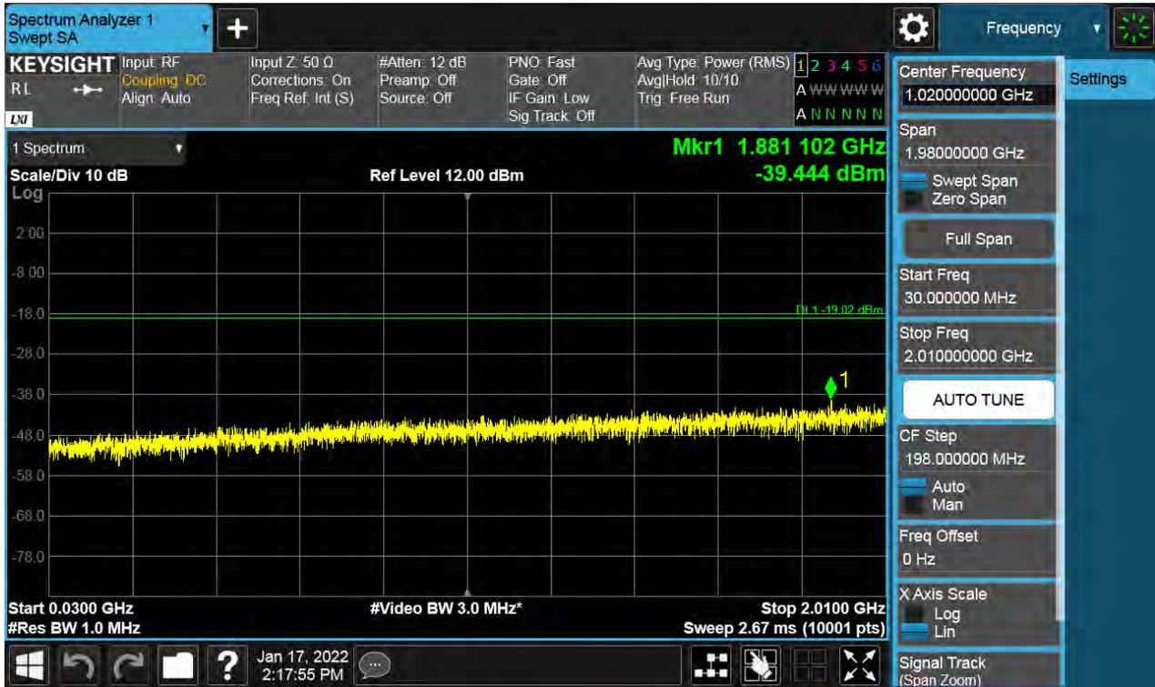
Antenna 0 / Low Edge - 100 MHz ~ Low Edge / (4 Port) 5G NR n66 20 MHz 1 Carrier / QPSK / Middle
