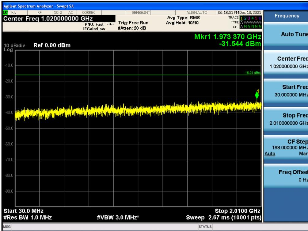
Antenna 1 / Low Edge - 100 MHz ~ Low Edge / (2 Port) LTE B66 10 MHz 1 Carrier / 16QAM / Middle
