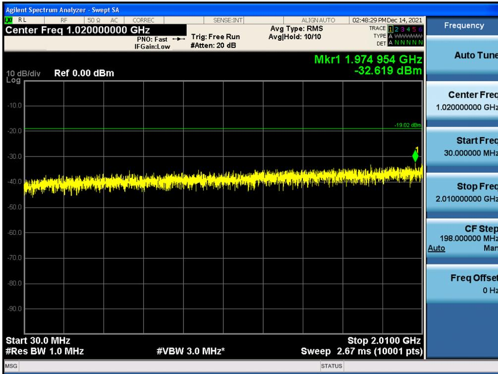
Antenna 3 / Low Edge - 100 MHz ~ Low Edge / (4 Port) LTE B66 10 MHz 1 Carrier / QPSK / High
