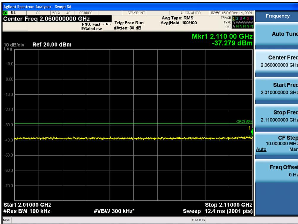
Antenna 3 / High Edge ~ High Edge + 100 MHz / (4 Port) LTE B66 10 MHz 1 Carrier / 16QAM / Middle
