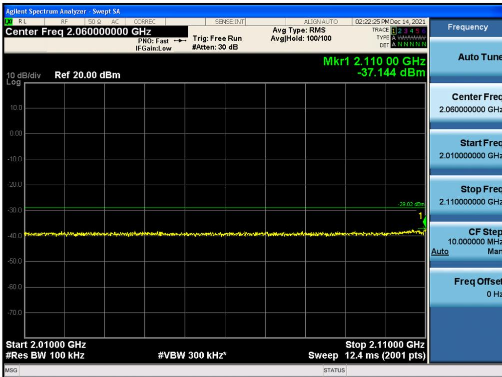
Antenna 0 / High Edge ~ High Edge + 100 MHz / (4 Port) LTE B66 5 MHz 1 Carrier / 16QAM / High
