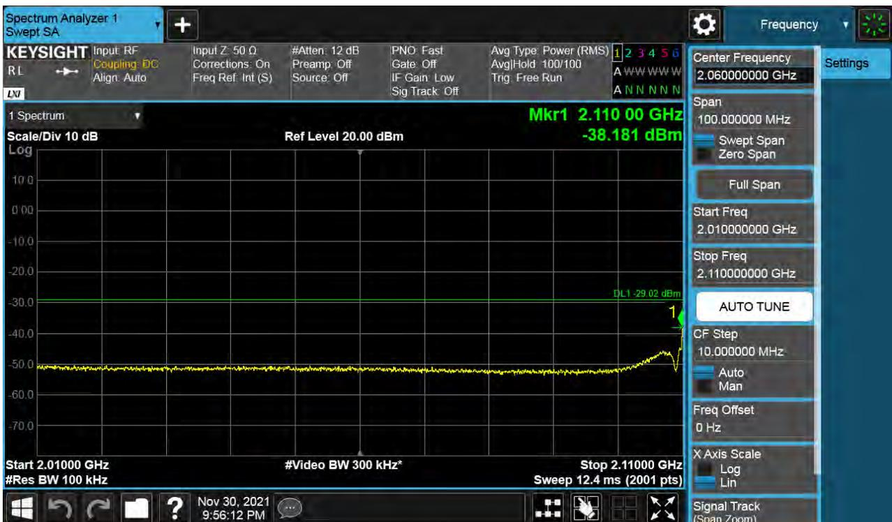
Antenna 0 / High Edge ~ High Edge + 100 MHz / (4 Port) B66 DSS 15 MHz 9to1 1 Carrier / 64QAM / High
