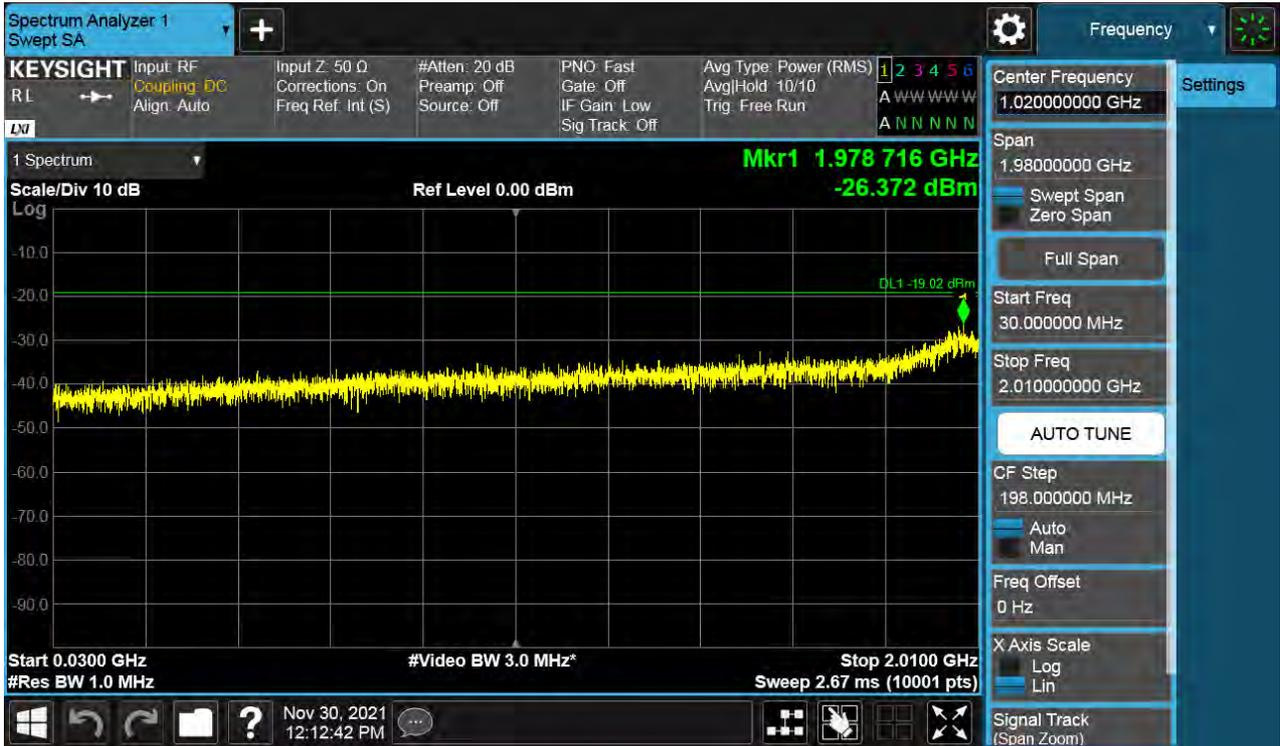
Antenna 0 / Low Edge - 100 MHz ~ Low Edge / (4 Port) B66 DSS 10 MHz 2to8 1 Carrier / 256QAM / High
