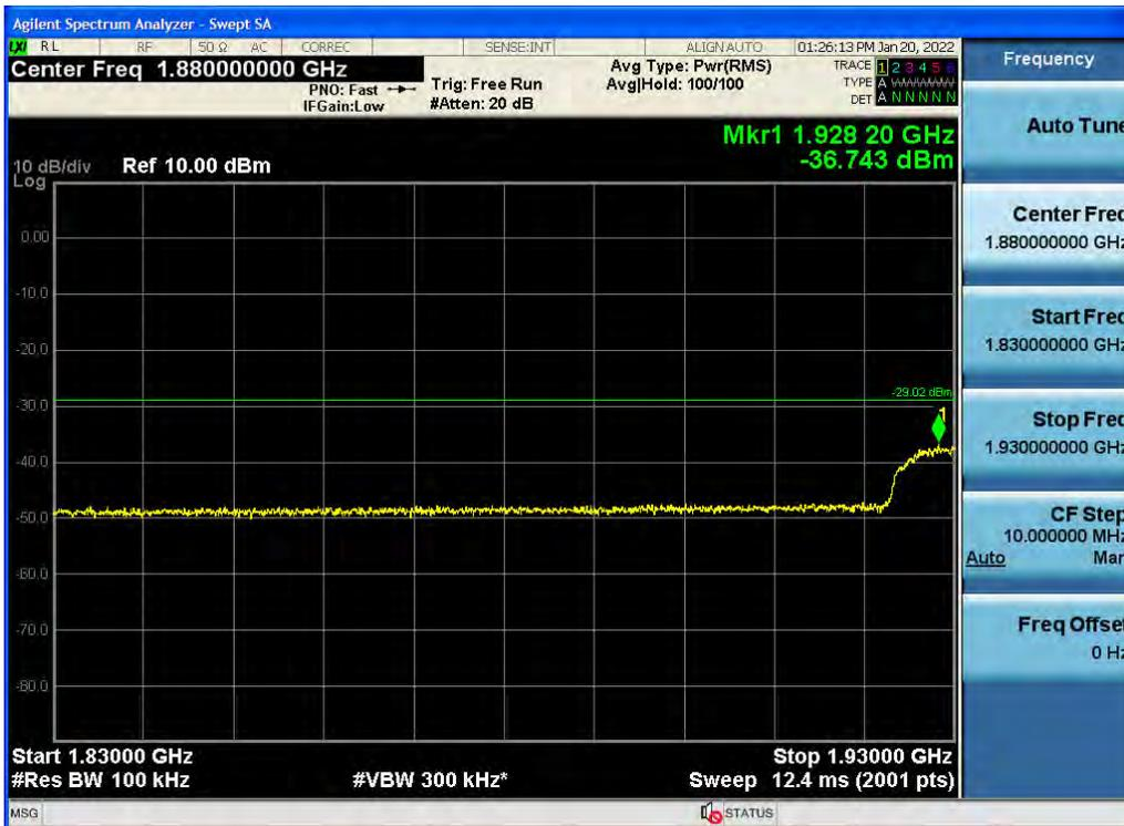
Antenna 0 / High Edge ~ High Edge + 100 MHz / (4 Port) 5G NR n2 15 MHz 1 Carrier / 256QAM / Middle
