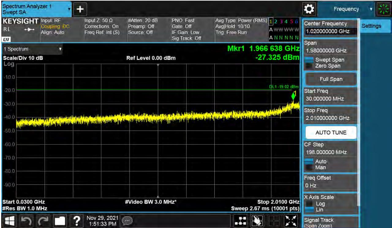
Antenna 0 / Low Edge - 100 MHz ~ Low Edge / (4 Port) B66 DSS 10 MHz 9to1 1 Carrier / 64QAM / Low
