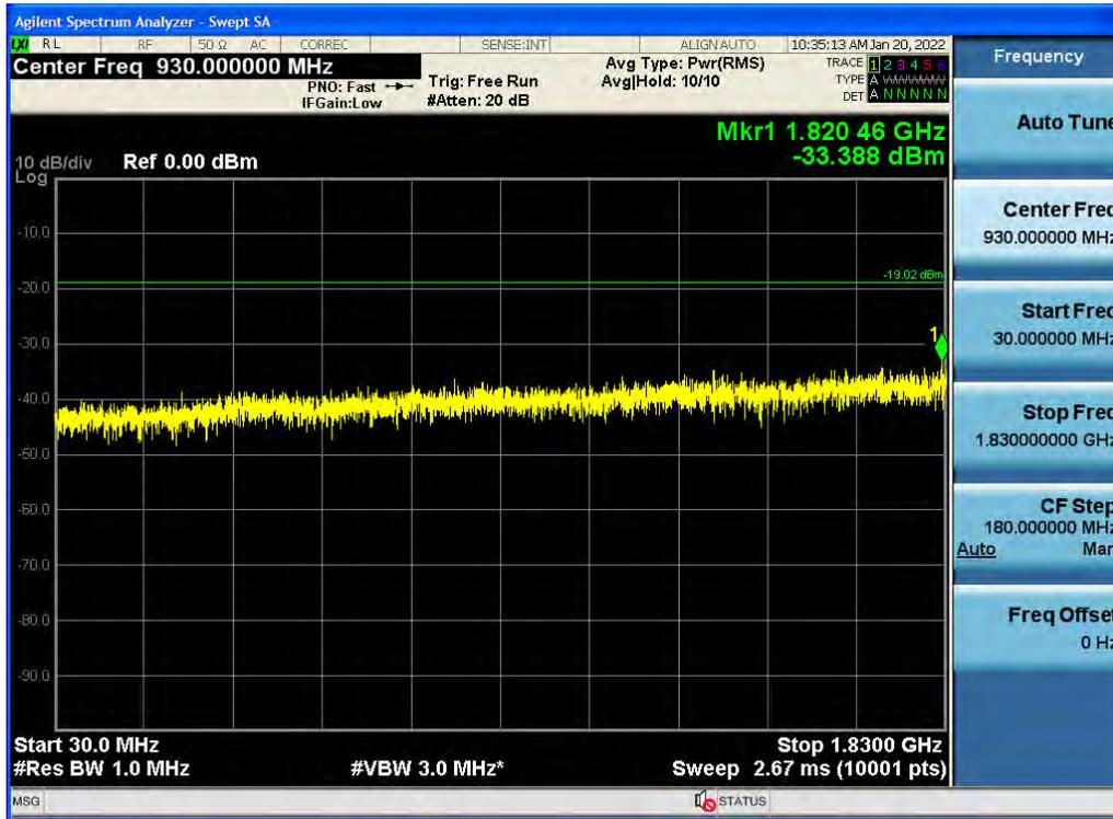
**Antenna 0 / Low Edge - 100 MHz ~ Low Edge / (4 Port) 5G NR n2 20 MHz 1 Carrier / QPSK / Middle**
