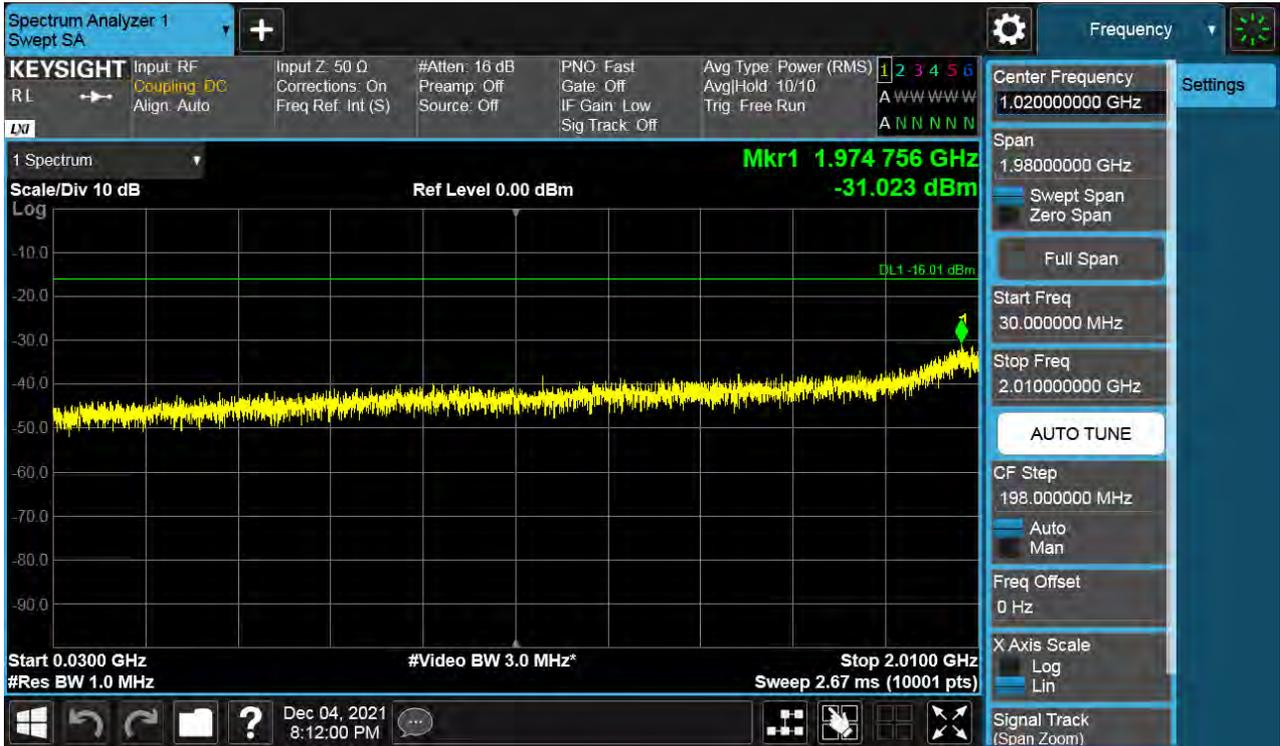
Antenna 0 / Low Edge - 100 MHz ~ Low Edge / (2 Port) B66 DSS 20 MHz 5to5 1 Carrier / 64QAM / Middle
