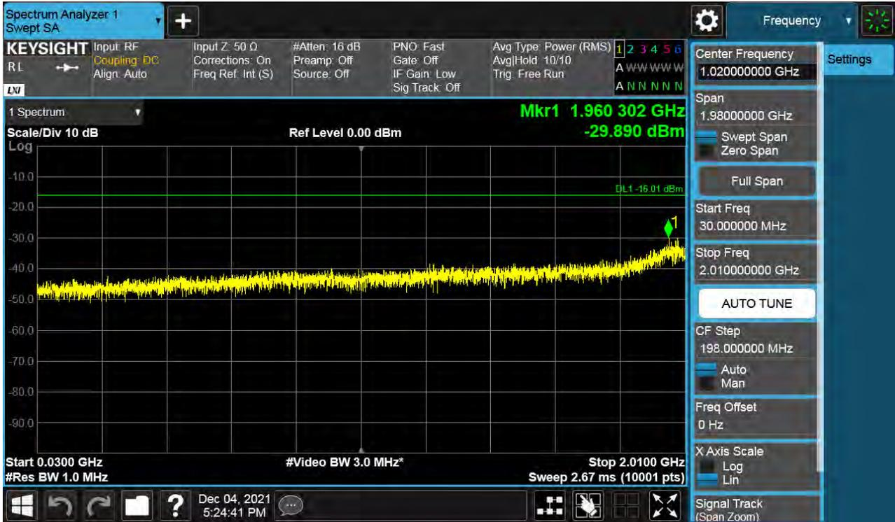
Antenna 0 / Low Edge - 100 MHz ~ Low Edge / (2 Port) B66 DSS 20 MHz 9to1 1 Carrier / 256QAM / Middle
