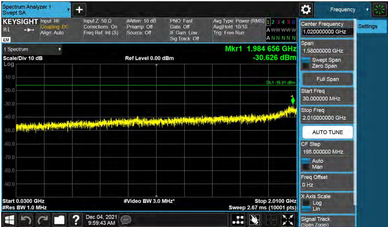
Antenna 0 / Low Edge - 100 MHz ~ Low Edge / (2 Port) B66 DSS 15 MHz 9to1 1 Carrier / 256QAM / Low
