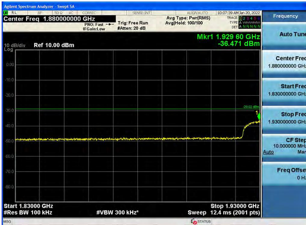
Antenna 0 / High Edge ~ High Edge + 100 MHz / (4 Port) 5G NR n2 20 MHz 1 Carrier / 64QAM / Middle
