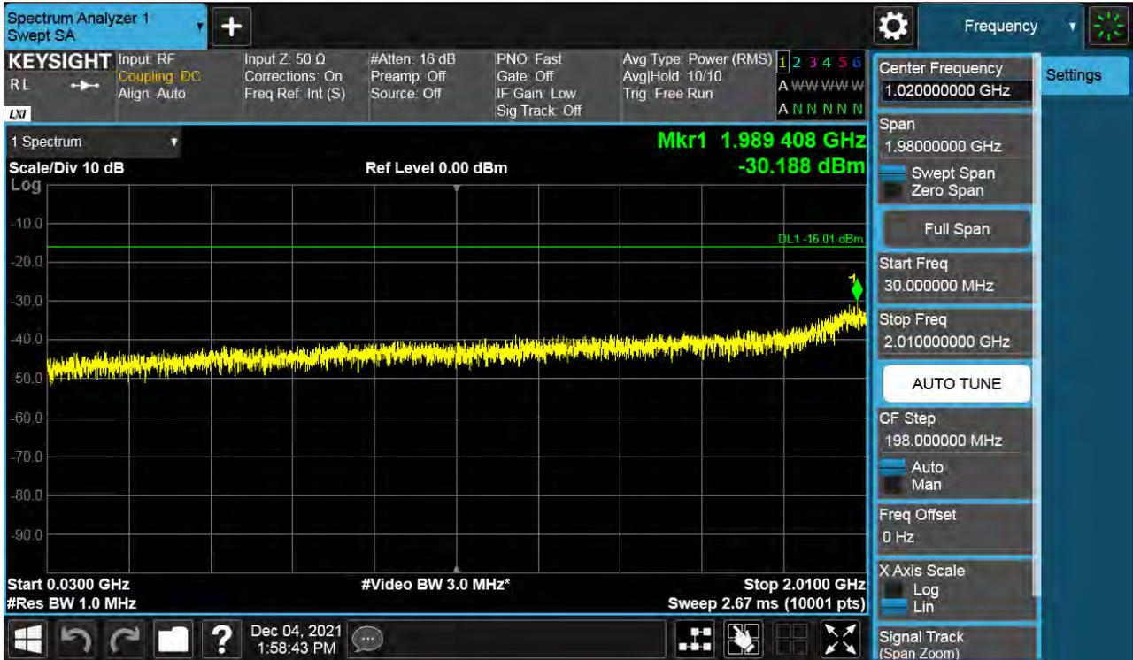
Antenna 0 / Low Edge - 100 MHz ~ Low Edge / (2 Port) B66 DSS 15 MHz 2to8 1 Carrier / 256QAM / Low
