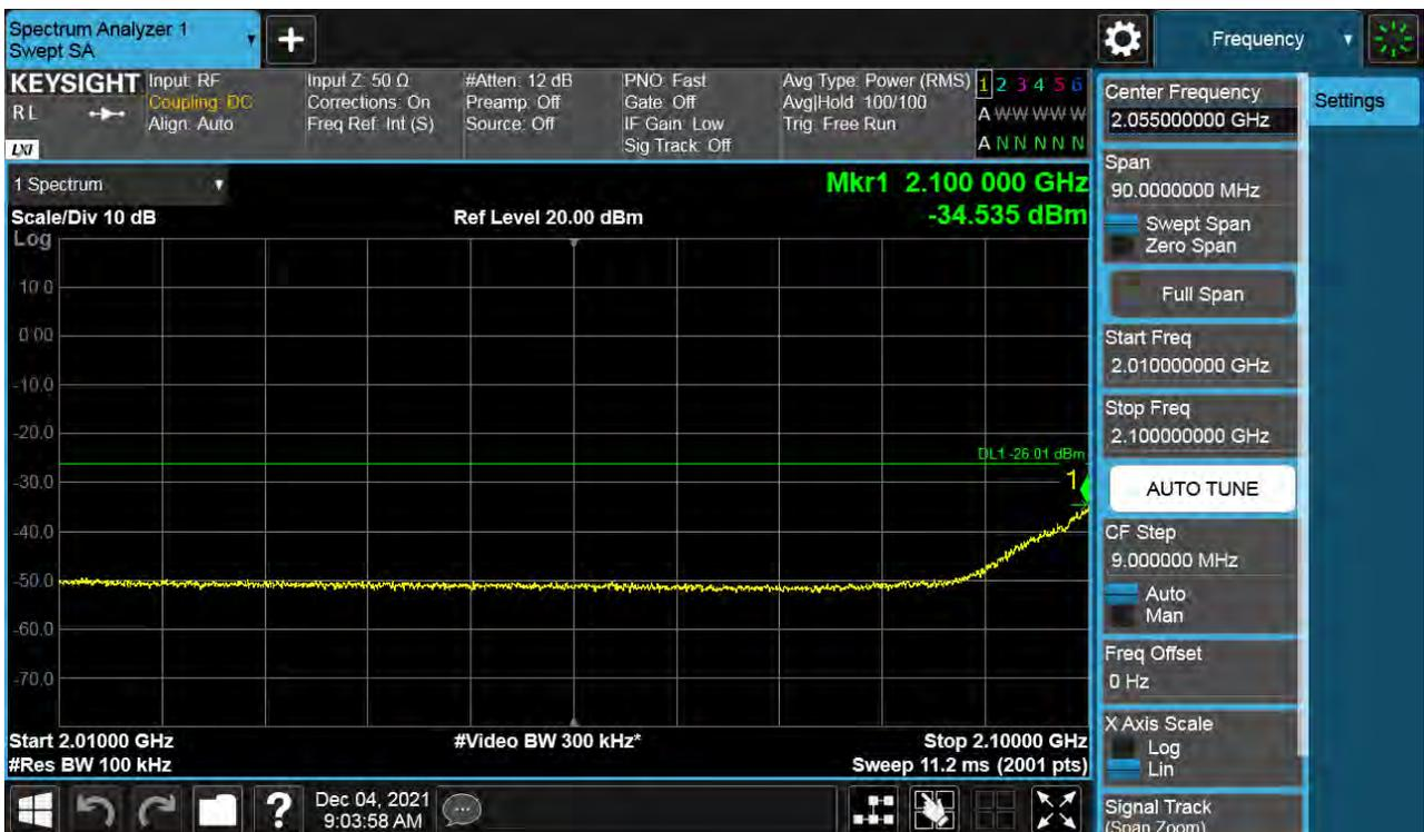
Antenna 0 / High Edge ~ High Edge + 100 MHz / (2 Port) B66 DSS 15 MHz 9to1 1 Carrier / 256QAM / High
