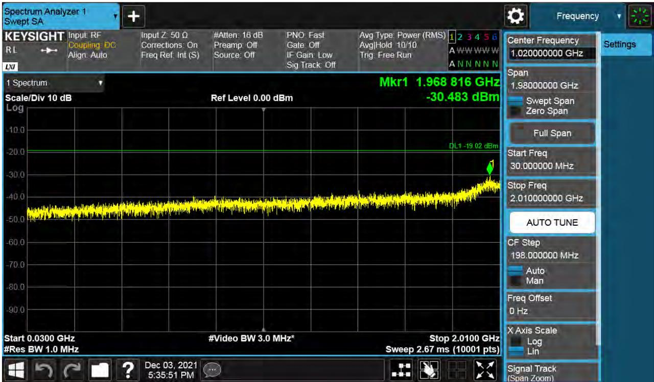
Antenna 1 / Low Edge - 100 MHz ~ Low Edge / (2 Port) B66 DSS 10 MHz 5to5 1 Carrier / QPSK / Middle
