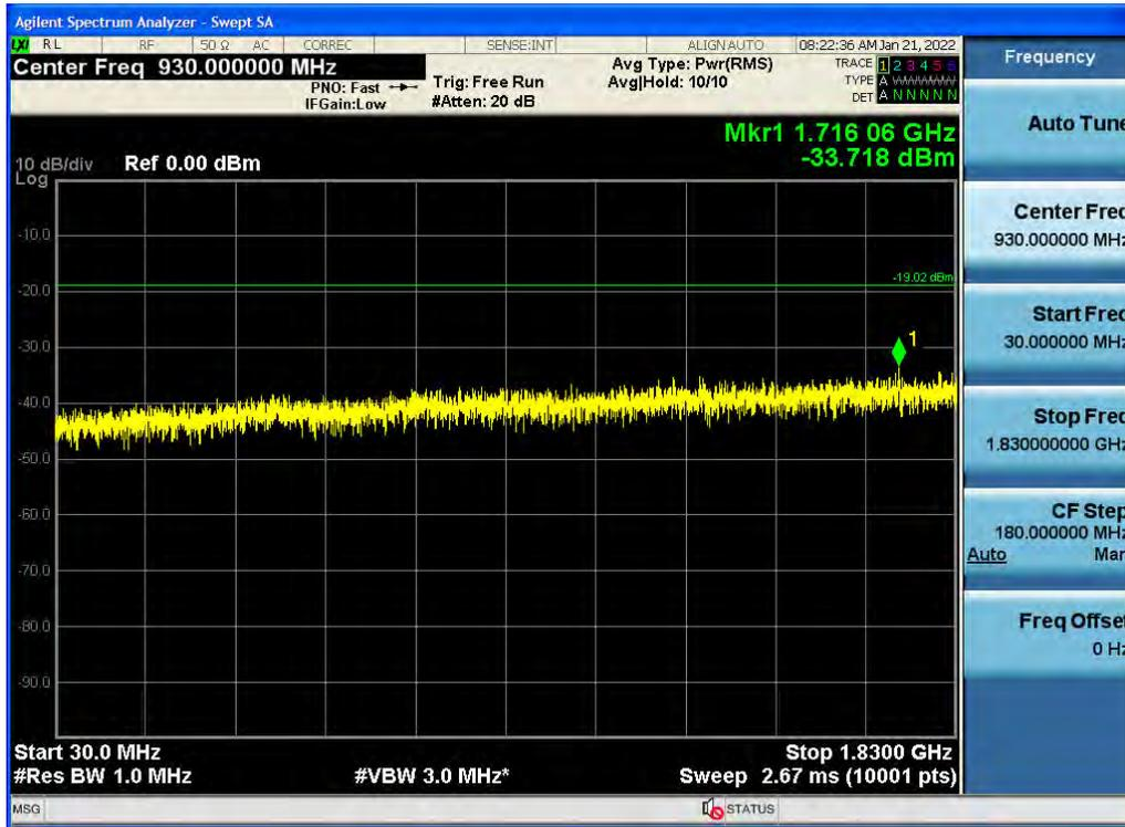
Antenna 3 / Low Edge - 100 MHz ~ Low Edge / (4 Port) 5G NR n2 5 MHz 1 Carrier / QPSK / Low
