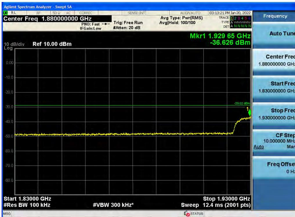
Antenna 0 / High Edge ~ High Edge + 100 MHz / (4 Port) 5G NR n2 10 MHz 1 Carrier / 64QAM / Middle
