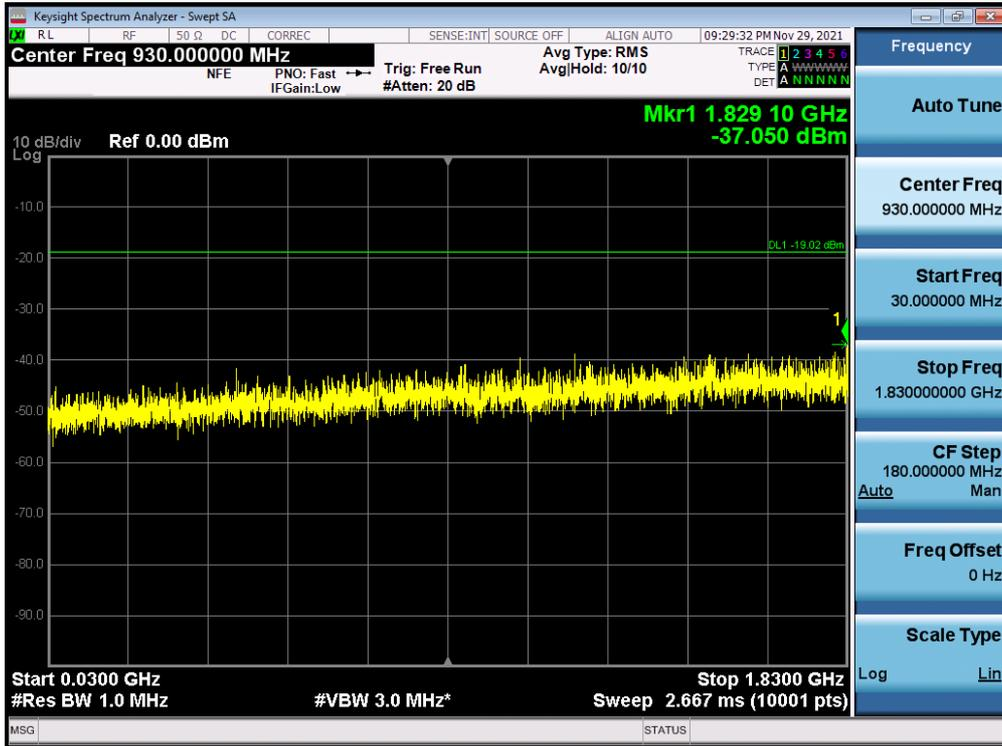
Antenna 0 / Low Edge - 100 MHz ~ Low Edge / (4 Port) B2 DSS 10 MHz 9to1 1 Carrier / 16QAM / Middle
