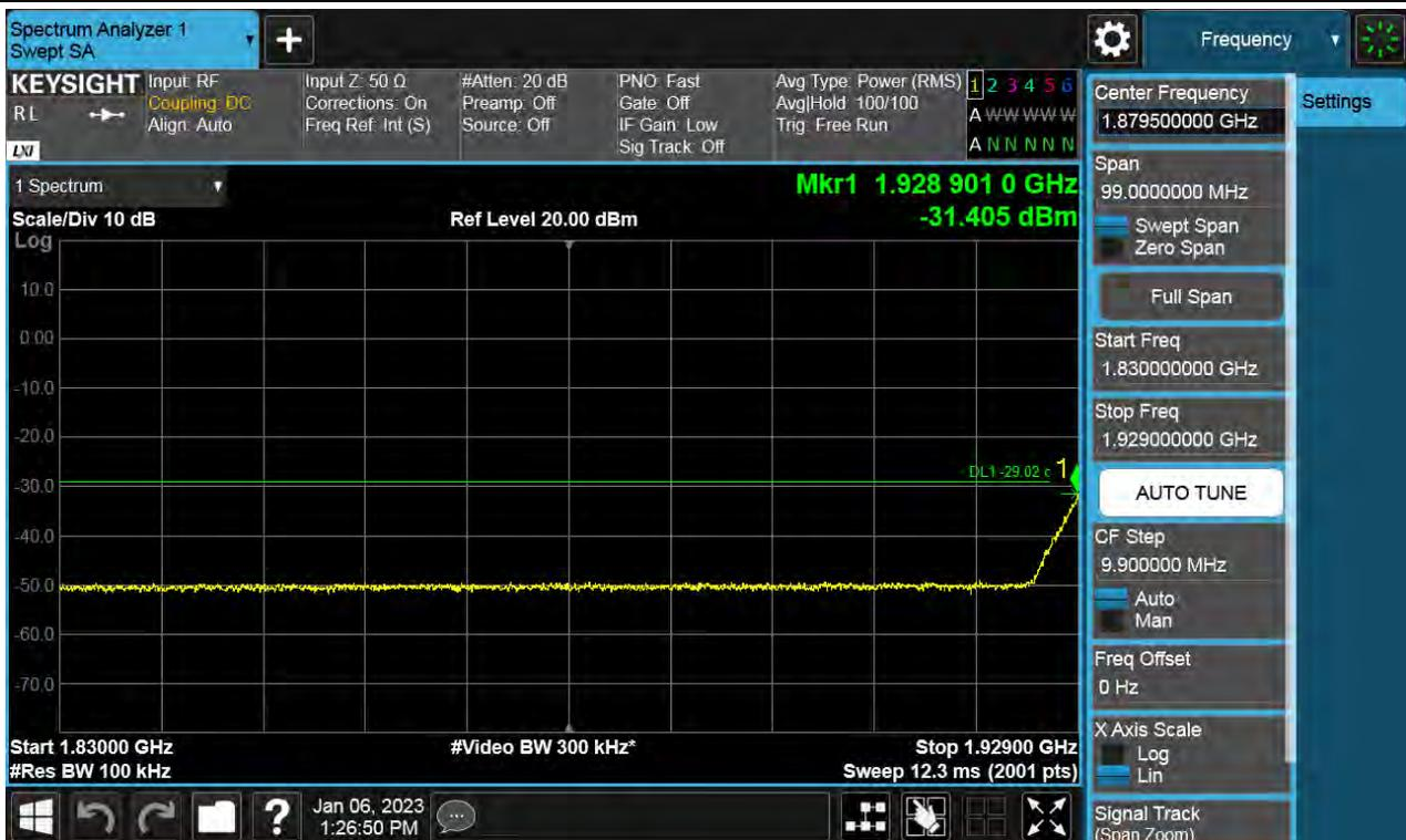
Antenna 0 / (4 Port) 5G NR n2 5 MHz 1 Carrier / High Edge ~ High Edge + 100 MHz / 16QAM / HIGH
