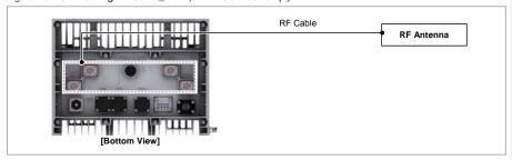
2 2T2R RF 케이블 연결과 동일한 방식으로 RF antenna ~ RRH(ANT 1, ANT 2, ANT 3, ANT 4) port 간 RF 케이블을 연결한다.
