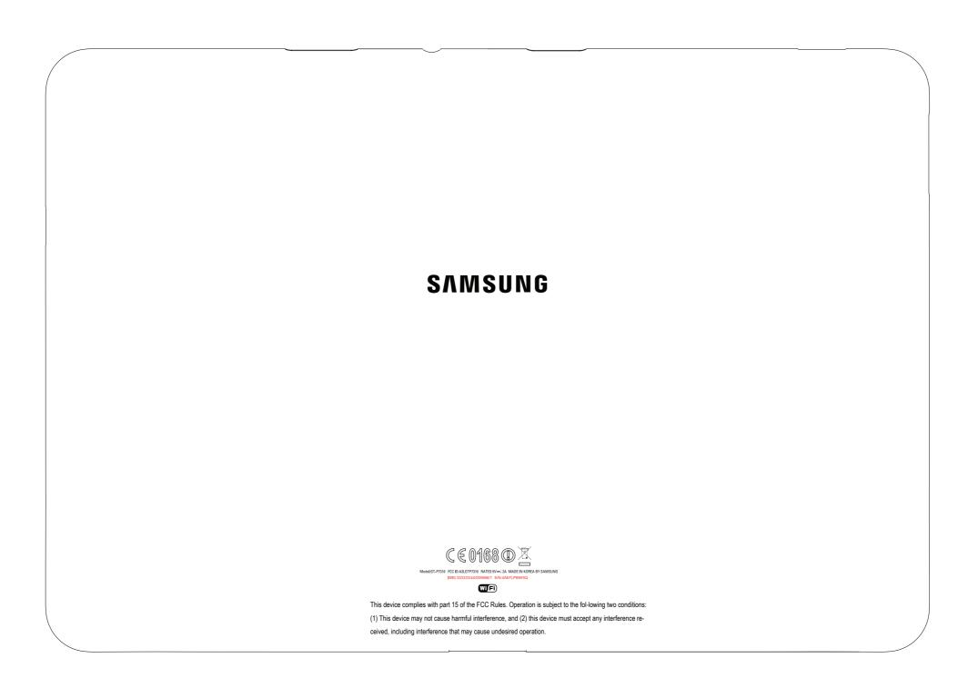
FCC ID IS PRINTED ON BOTTOM OF THE DEVICE
