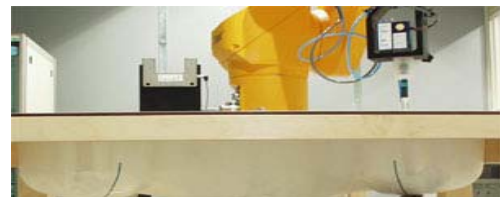
Figure3.5 SAM Twin Phantom
