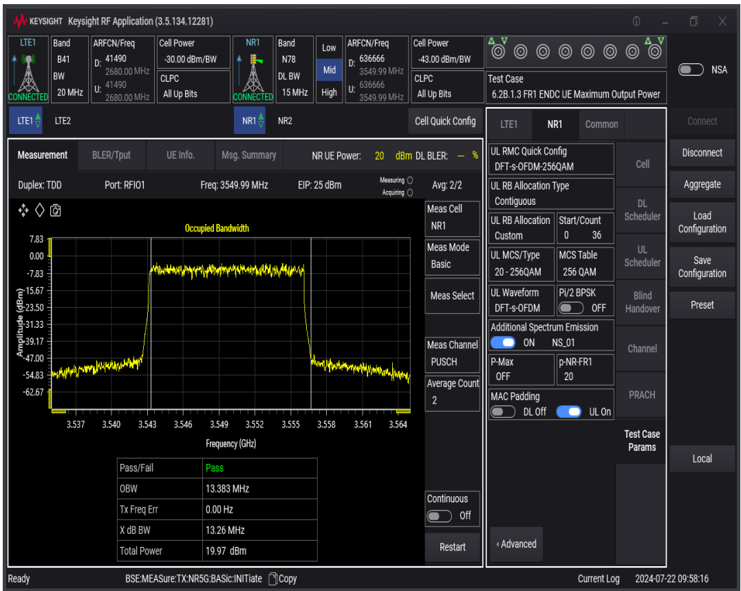
n78 SCS=30kHz DFT_QAM256 BW=20MHz Channel=636666 RB=50@0
