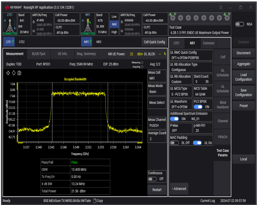
n78 SCS=30kHz DFT_BPSK BW=20MHz Channel=636666 RB=50@0
