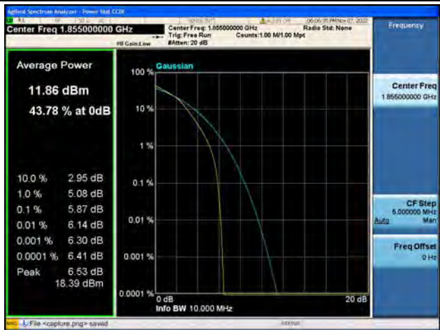
Band2 / 10MHz / Low CH / 16QAM
