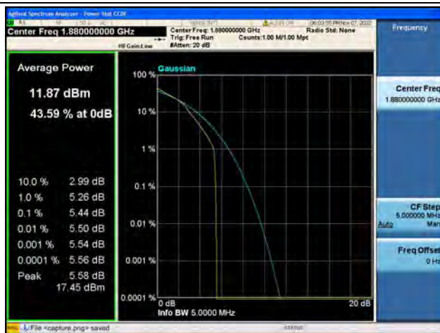
Band2 / 1.4MHz / Mid CH / 16QAM
