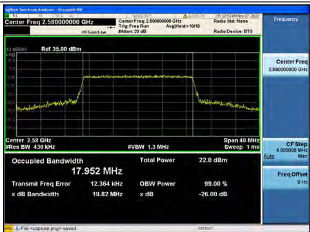
Band38 / 20MHz / 16QAM / Low CH
