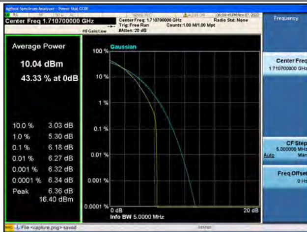
Band4 / 1.4MHz / Low CH / 64QAM
