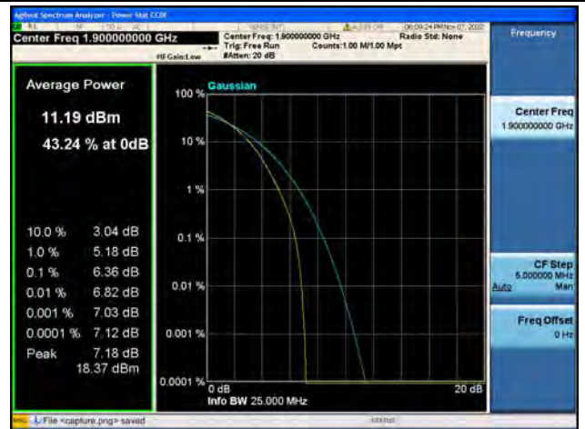
Band2 / 20MHz / High CH / 64QAM
