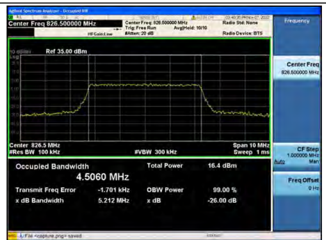
Band5 / 5MHz / 16QAM / Low CH
