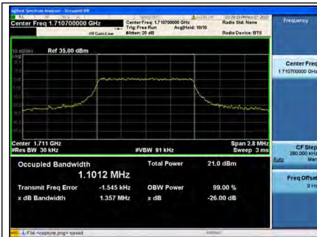
Band4 / 1.4MHz / QPSK/ Low CH
