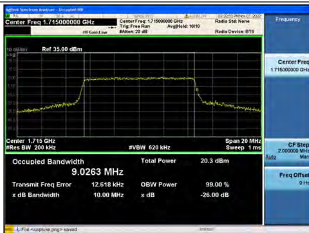
Band4 / 10MHz / 16QAM / Low CH
