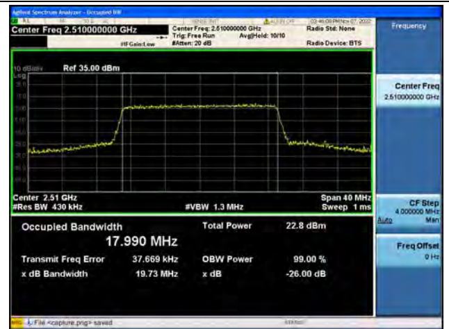
Band7 / 20MHz / QPSK/ Low CH
