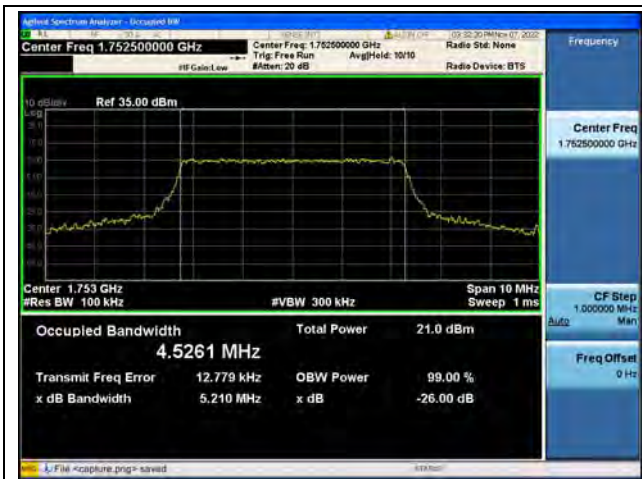
Band4 / 5MHz / QPSK / High CH
