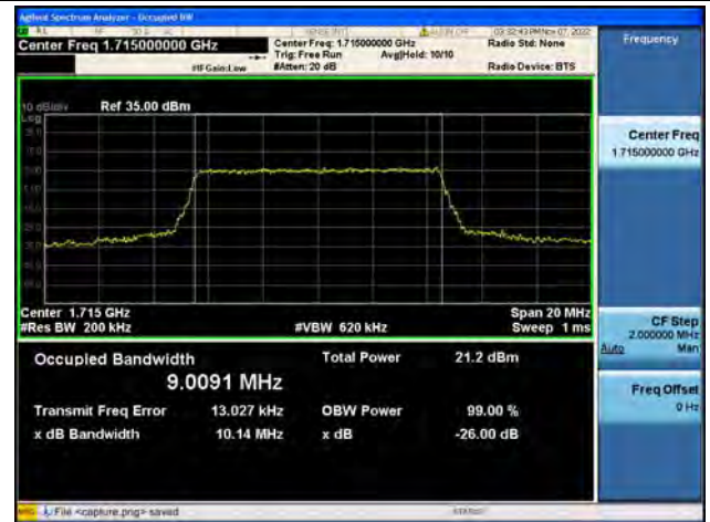
Band4 / 10MHz / QPSK / Low CH
